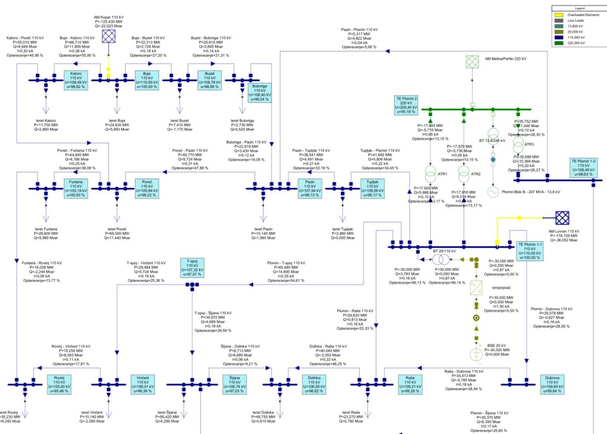
Slika 5.6. Scenarij maksimalnog opterećenja i isпадa TE Plomin, s BSE 30 MW
