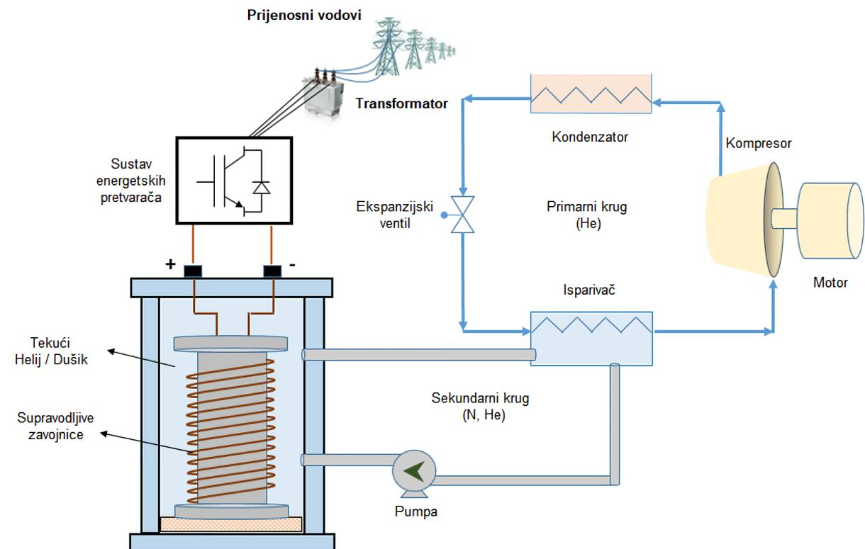
Slika 2.7. Shematski prikaz supravodljivog magneta (SMES) [13]
