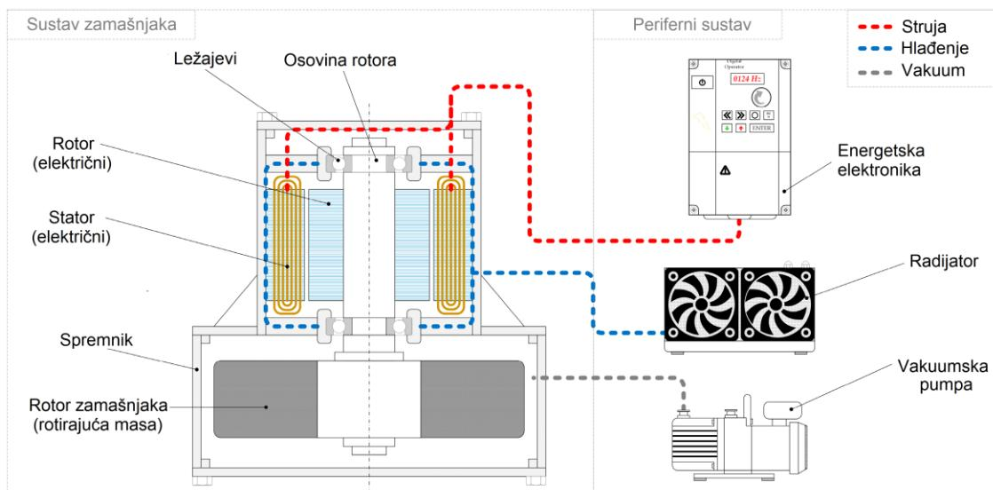
Slika 2.5. Shematski prikaz sustava zamašnjaka [10]
