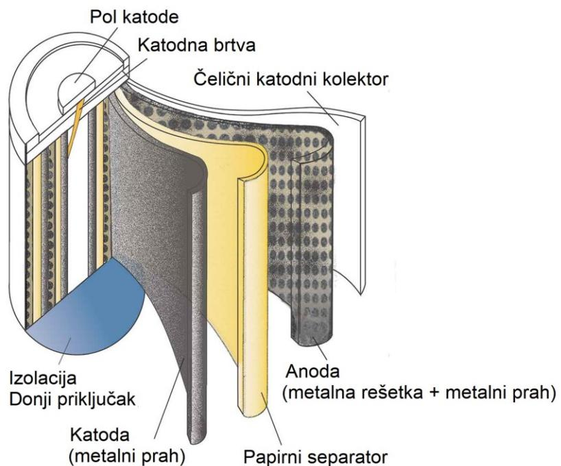
Slika 3.3. Presjek nikal-metal-hidrid (Ni-MH) baterije [25]
