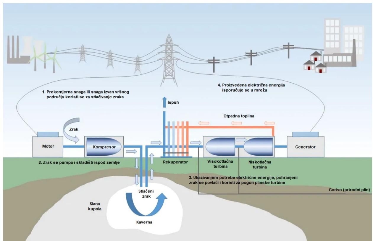
Slika 2.4. Shematski prikaz sustava pohrane komprimiranog zraka (CAES) [9]
