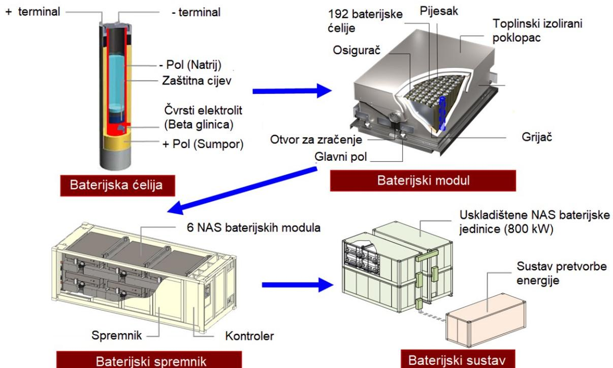
Slika 3.4. Shema NaS baterijskog spremnika (sustava) [26]
