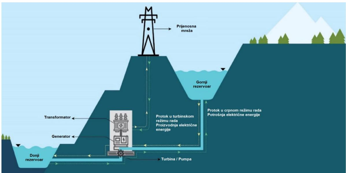
Slika 2.3. Shematski prikaz načina rada reverzibilne hidroelektrane (PHES) [4]
