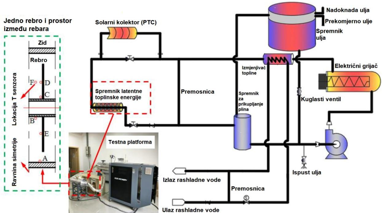
Slika 2.14. Shema eksperimentalne pohrane latentne topline [22]
