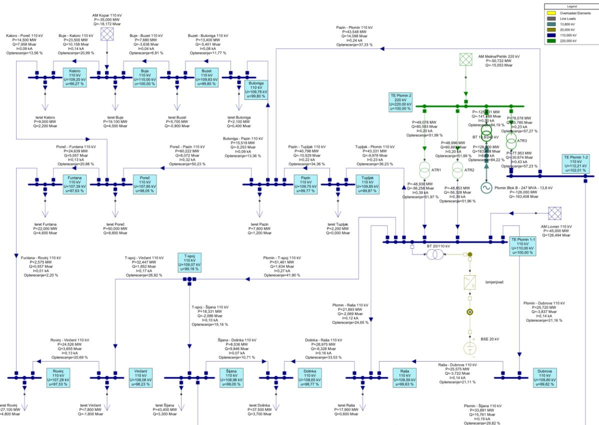
Slika 5.3. Stanje podsustava tijekom normalnog pogonskog stanja
