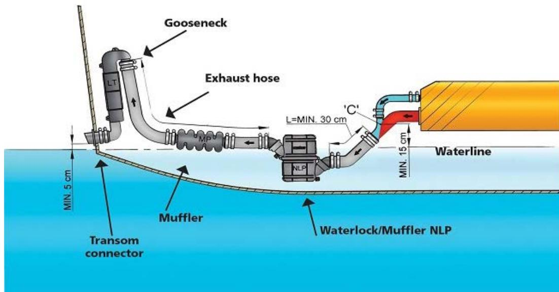
Slika 3.8.1.: Primjer ispušnog sustava iznad vodne linije
