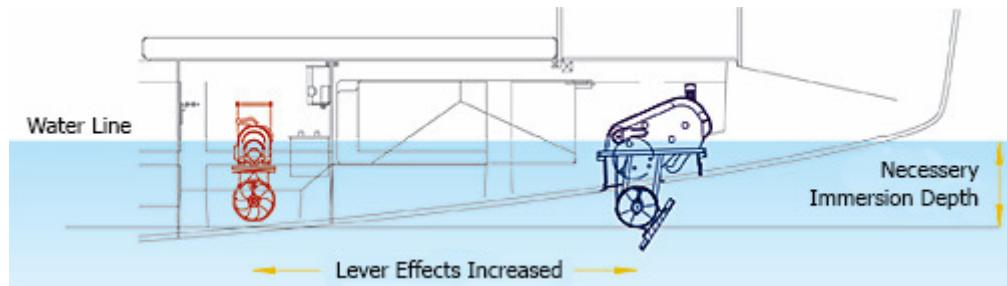
*Slika 3.7.2.2.: Pramčani porivnik sa mehanizmom spuštanja propellerskog sklopa porivnika izvan trupa broda*
