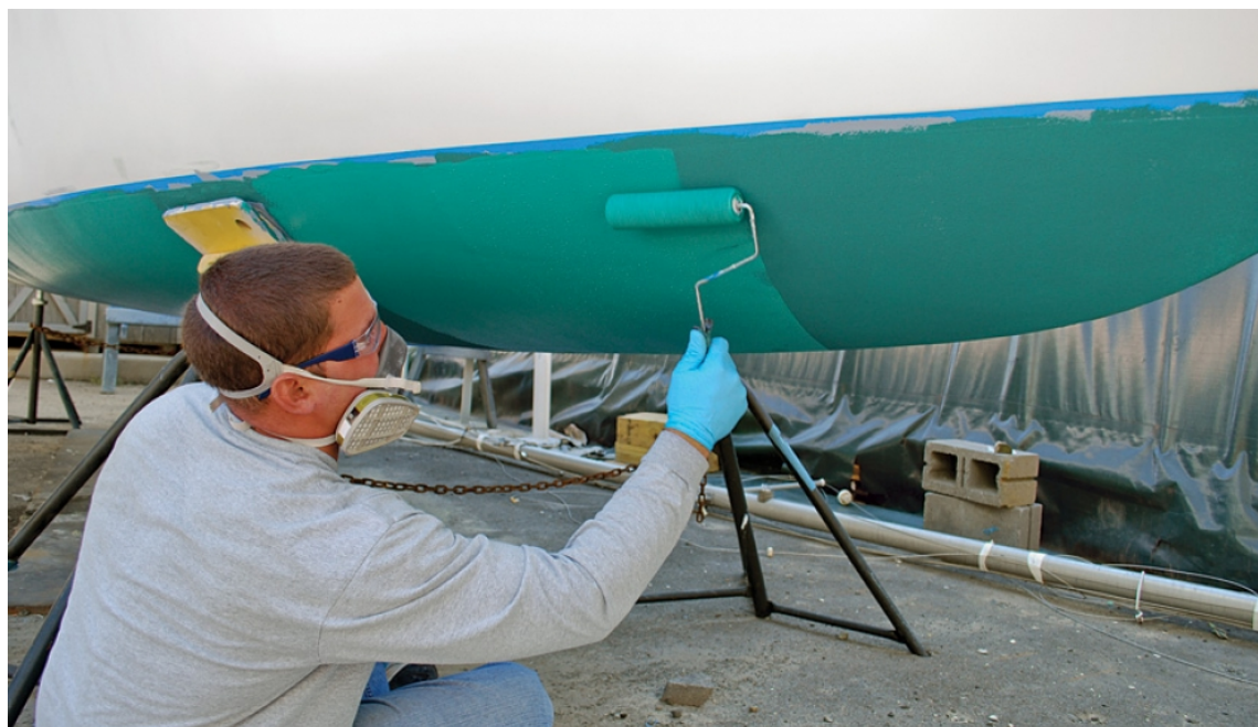
Slika 3.7.1.1.: Postavljanje antivegetativne zaštite na trup jedrilice
