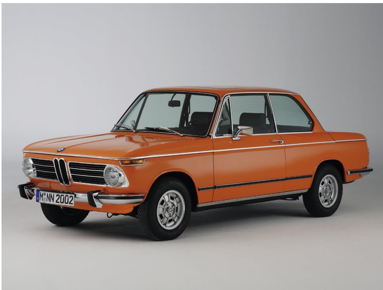
Slika 3.25. Izgled ne optimalnog aerodinamičkog dizajna automobila – BMW 2002 Turbo [43]
