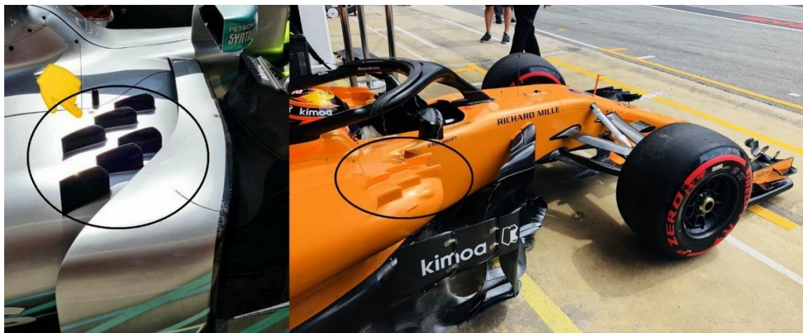
Slika 3.19. Generatori vrtloga kod Formule 1 [37]
