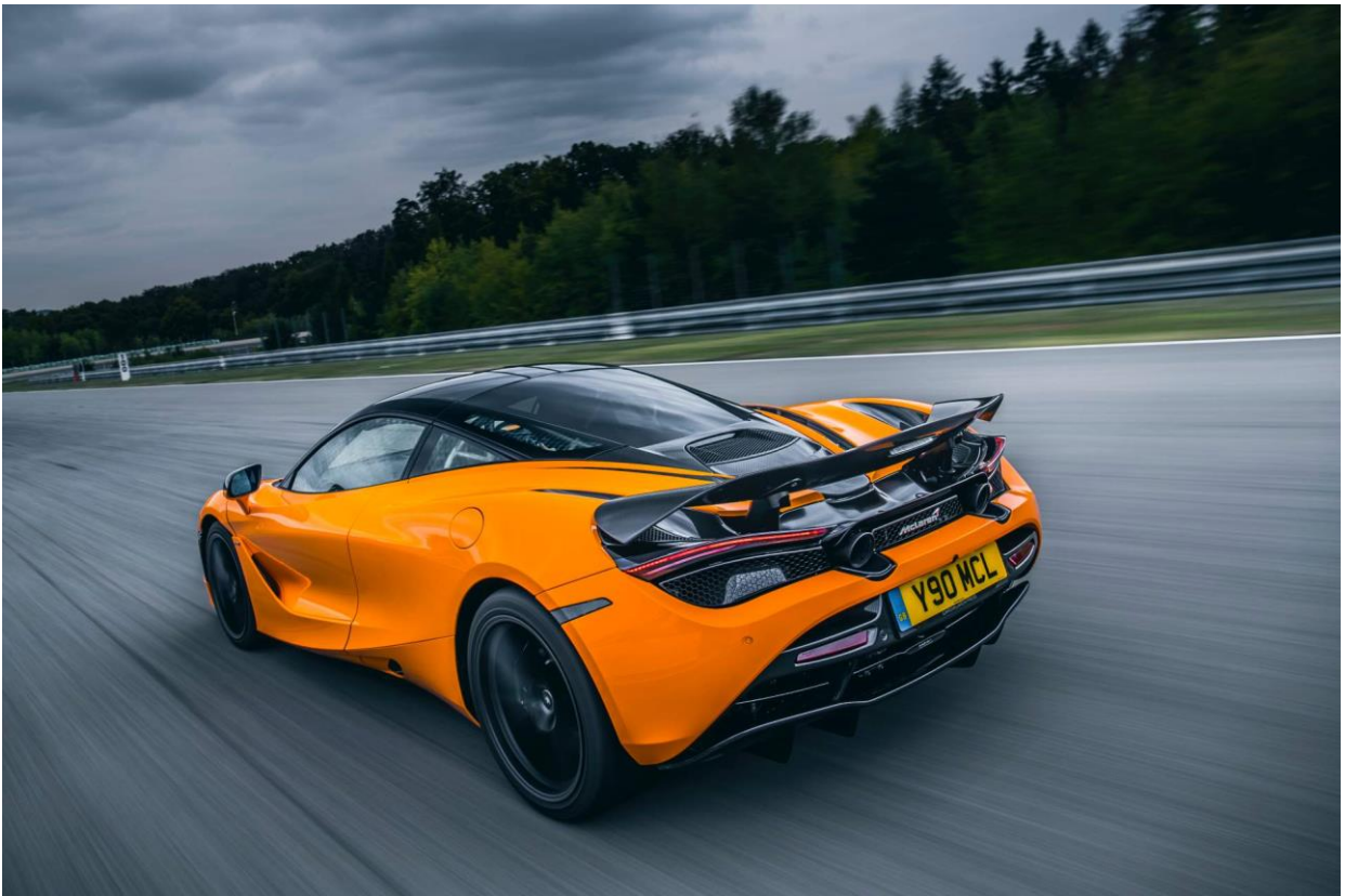
Slika 3.24. McLaren automobil s aktiviranim stražnjim krilom [42]
