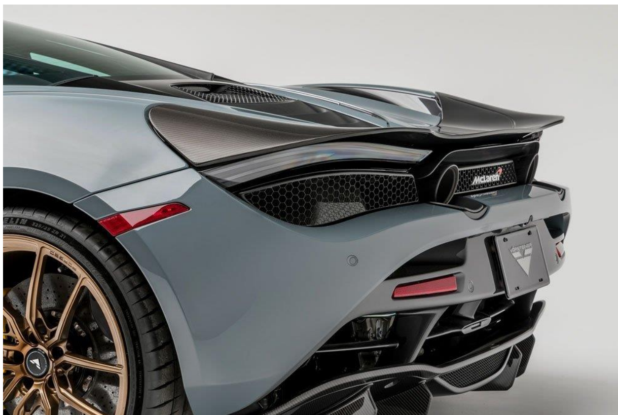
Slika 3.23. McLaren automobil sa spuštenim stražnjim krilom [41]
