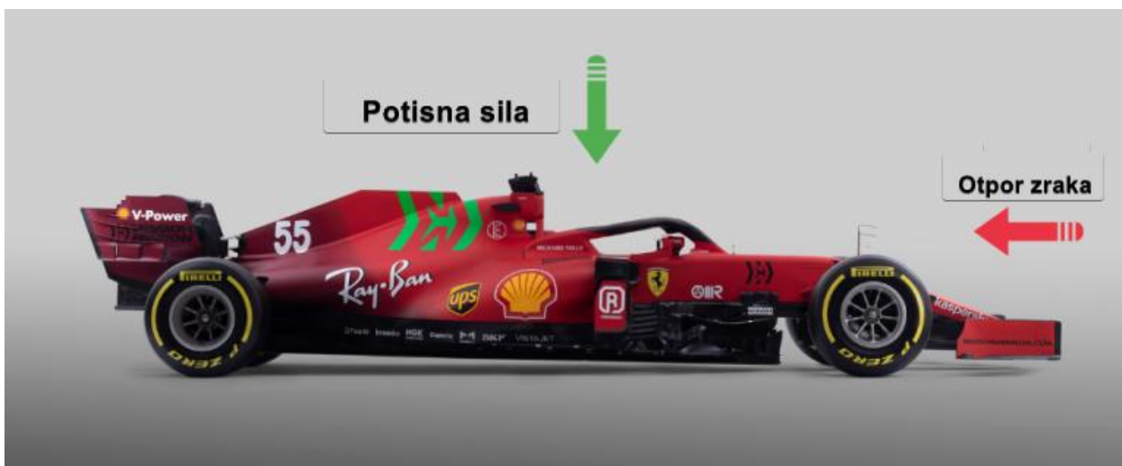
Slika 3.5. Smjer djelovanja potisne sile i otpora zraka [25]
