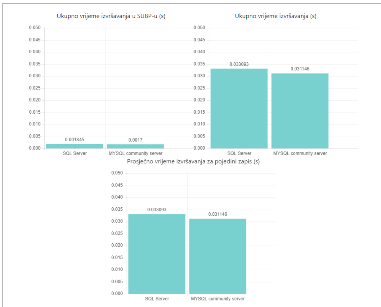
Slika 6.1 Primjer rezultata za zapisivanje jednog podatka veličine 1KB
