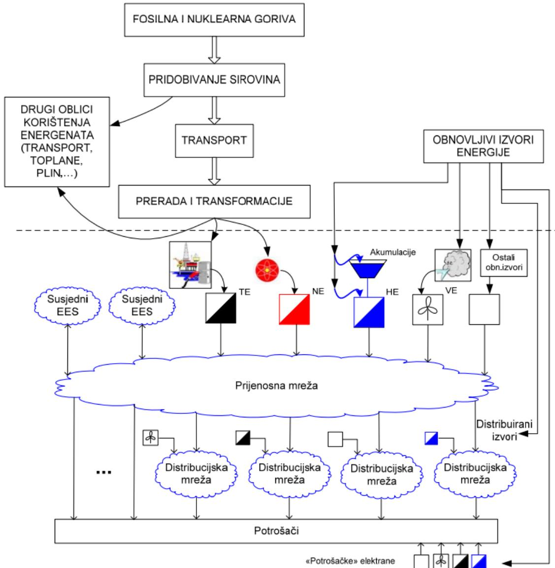
Slika 2.1. Prikaz osnovnih cjelina elektroenergetskog sustava. Izvor: [1]
