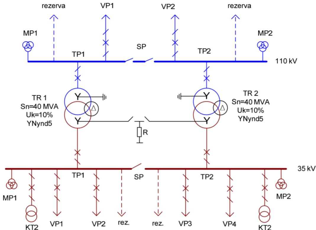
*Slika 4.1. Prikaz izvedbe transformatorske stanice 110/35 kV. Izvor: [1]*
