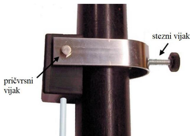
Slika 6.20. Prikaz postupka instalacije senzora tipa SK. Izvor: [15]
