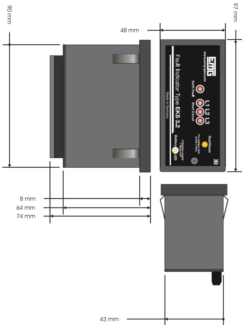
Slika 6.16. Prikaz dimenzija kućišta indikatora kvarova. Izvor: [15]
