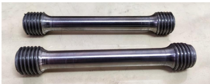
Slika 5.6. Uzorci za vlačno ispitivanje
