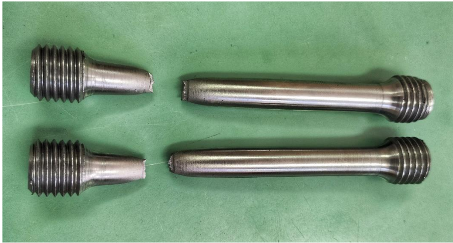
Slika 5.10. Vlačno ispitani uzorci
