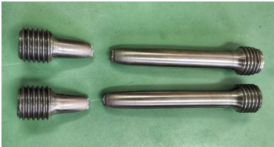
Slika 5.10. Vlačno ispitani uzorci
