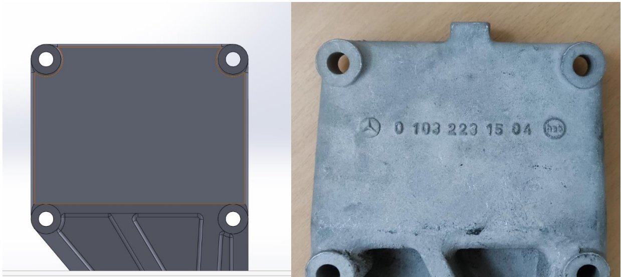
Slika 6. Izostavljeni detalji nosača motora
