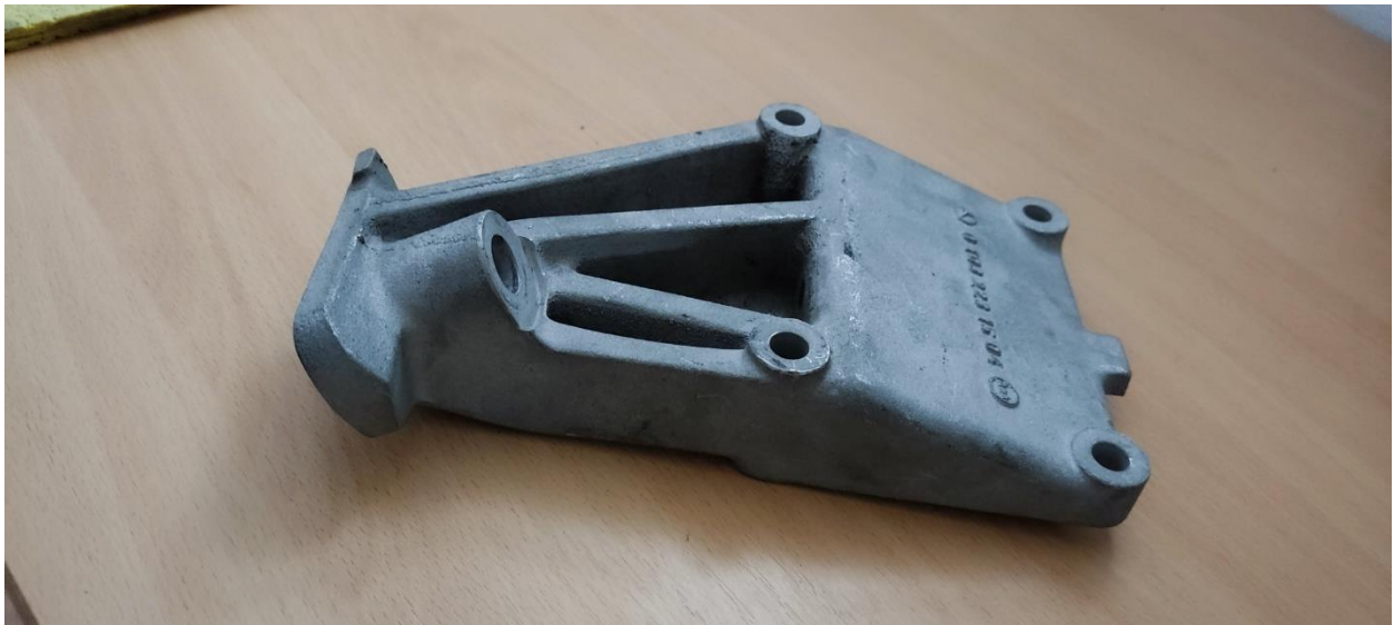
Slika 3. Lijevi nosač motora
