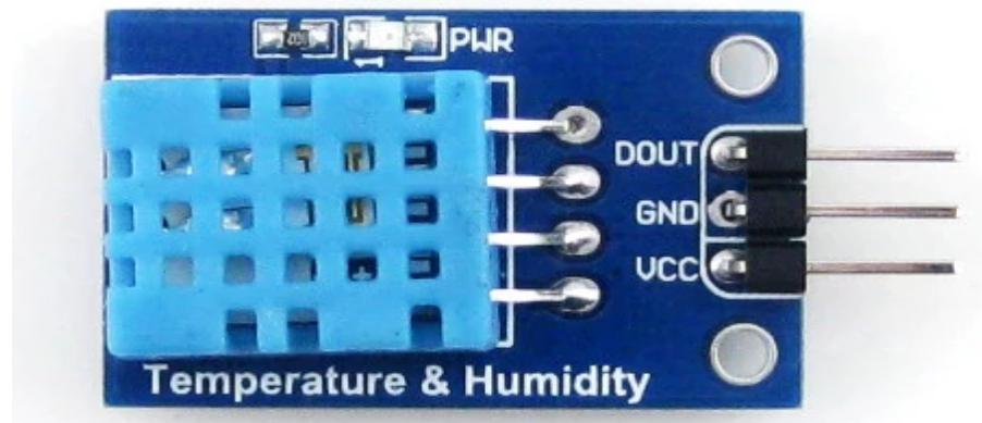
Slika 2.2.1 DHT11 senzor [9]
