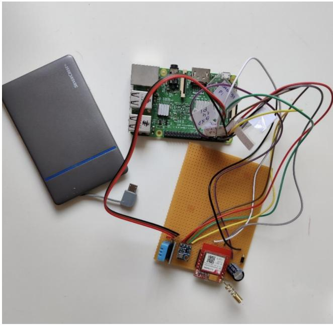
*Slika 2.6.1. Cijeli sklop na PCB pločici bez plutače*
