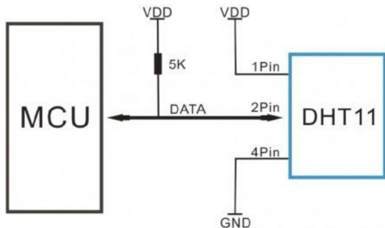
Slika 2.2.2 Shema spajanja DHT11 senzora s miktokontrolerom [23]
