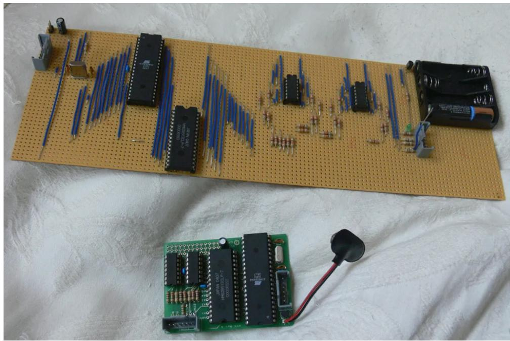
Slika 2.1.1 Razvoj i prototip Raspberry Pi-a [21]
