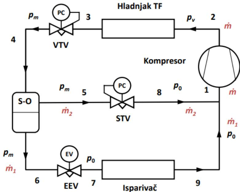
Slika 4. 20 - Shema transkriticnog jednostupanjskog procesa [32]
