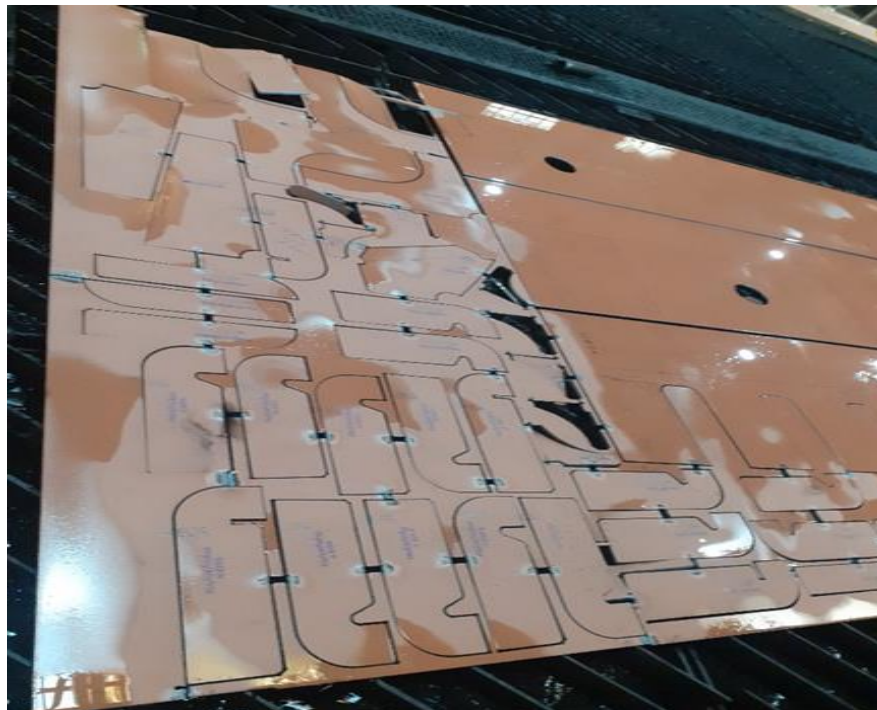
Slika 4.4 Prprema za rezanje lima brodskog trupa po uputama kontrolora za sljedivost. Obrisne konture i početni položaj rezanja. Priložen dokument kojim se potvrđuje korištenje izvornih slika brodogradilišta 3. Maj
