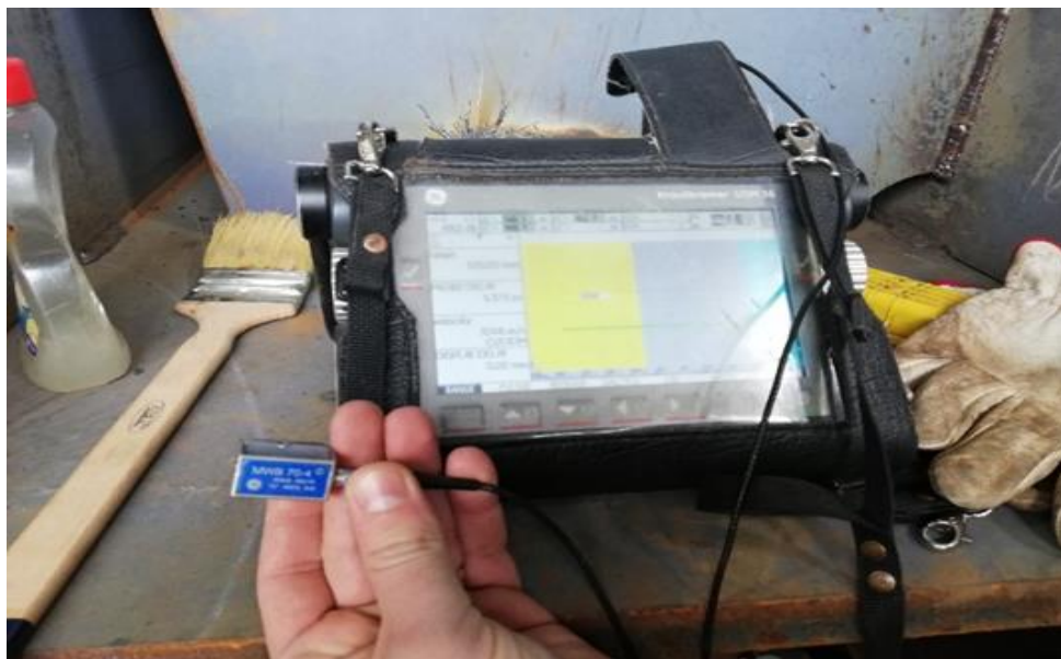
Slika 4.16 Ultrazvučno ispitivanje, oprema kojom se ispituje zavareni spoj, te prikazu postupak pripreme pred ispitivanje paljenje aparata te prikazuje memoriranje sa sondom od 70°. Priložen dokument kojim se potvrđuje korištenje izvornih slika brodogradilišta 3. Maj
