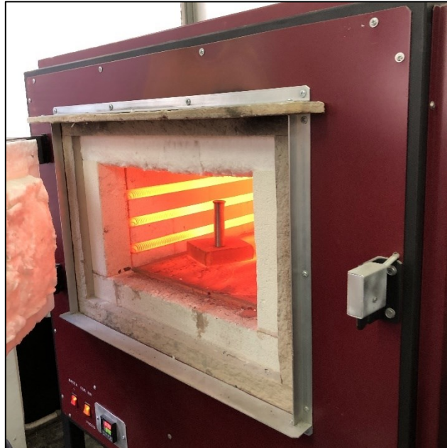
Slika 5.5. Ispitna epruveta u komornoj peći
