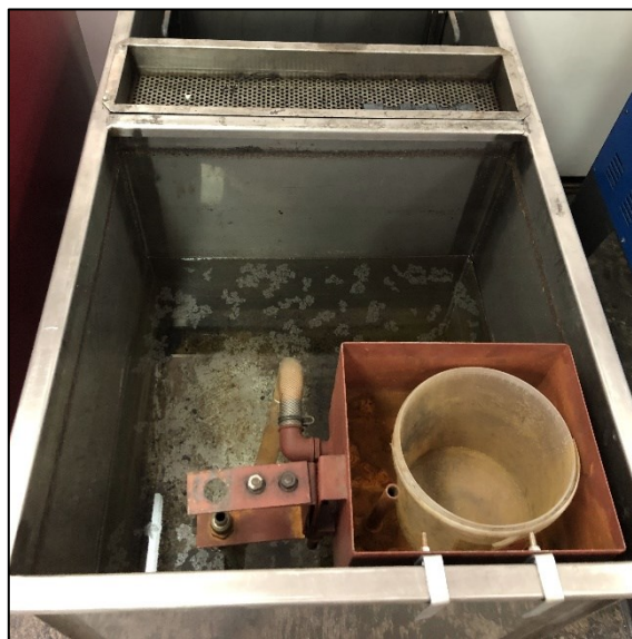
Slika 5.6. Naprava za gašenje Jominyjevog uzorka
