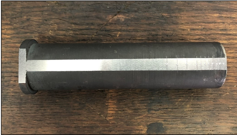
Slika 5.17. Ispitana Jominyjeva epruveta
