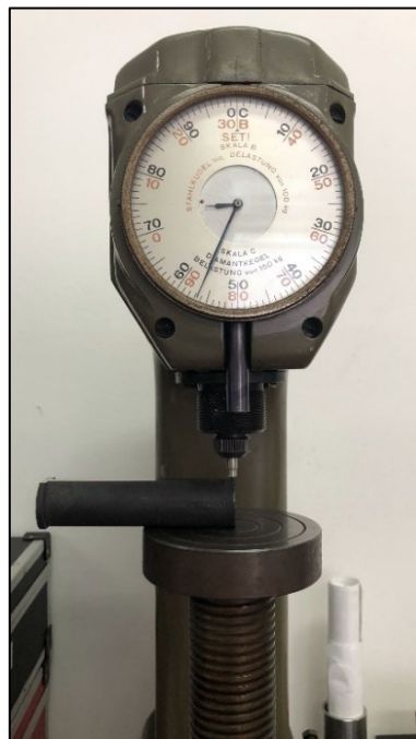
Slika 5.16. Ispitivanje tvrdoće na tvrdomjeru
