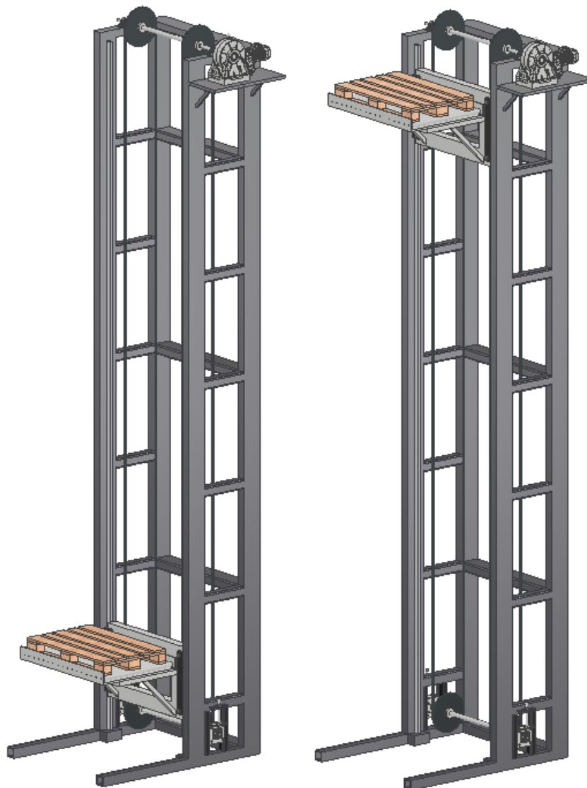
Slika 10.3 Prikaz rada elevatora u gornjoj i donjoj poziciji
