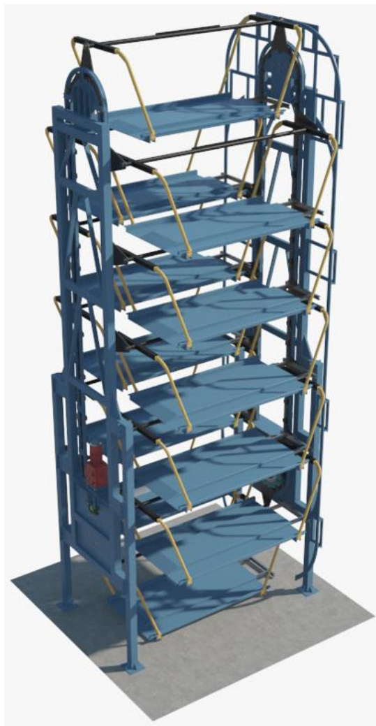
Slika 3.6 Elevator s ovješnim nosačima [6]
