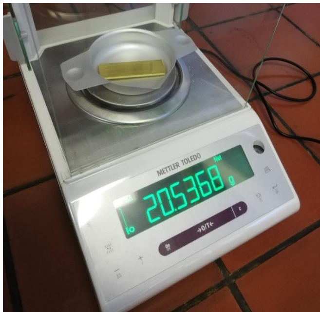
Slika 6.9. Vaganje ispitnih uzoraka - mjed
