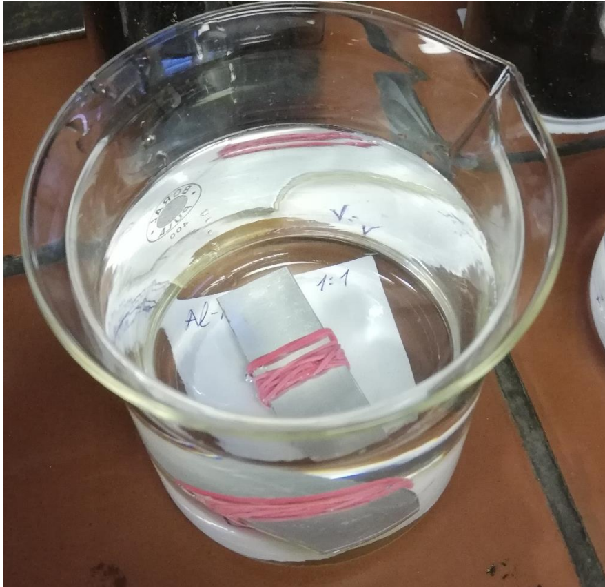
Slika 6.12. Ispitni uzorak u slatkoj vodi
