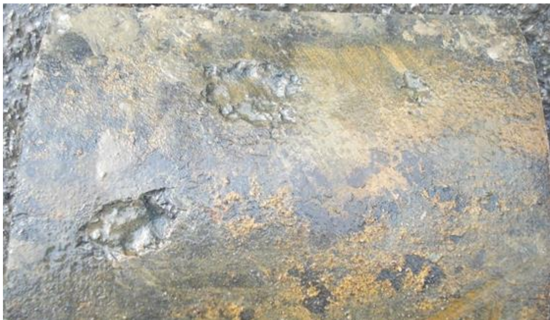
Slika 5.8. Grafitizacija sivog lijeva [30]
