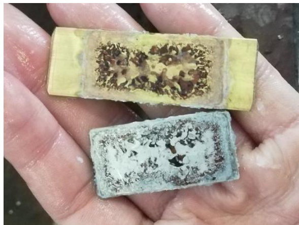
Slika 6.27. Razdvojena kombinacija aluminija i mjedi u morskoj vodi u omjeru 2:3 (uzorak 12)
