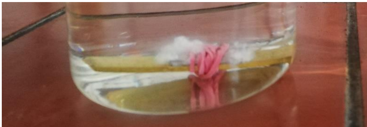
Slika 6.19. Kombinacija aluminija i mjedi u slatkoj vodi u omjeru 1:3 (uzorak 16) – prvi pregled
