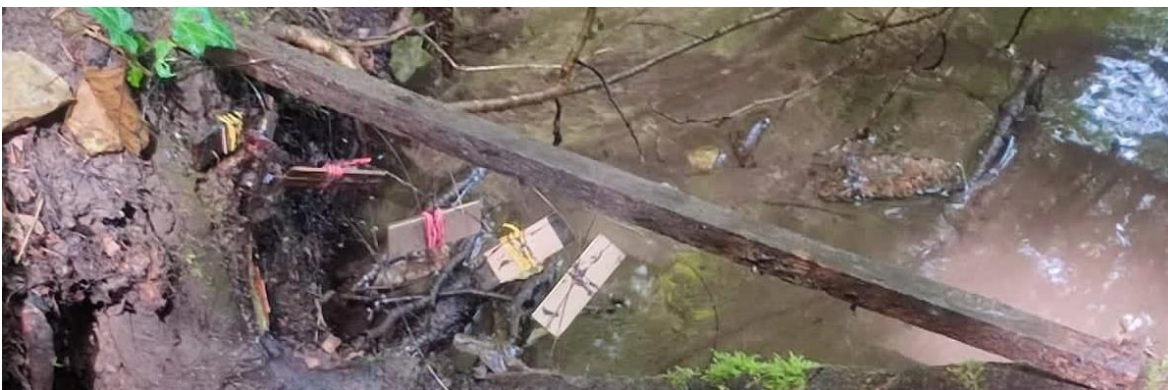
Slika 6.26. Ispitni uzorci izvađeni iz šumskog potoka
