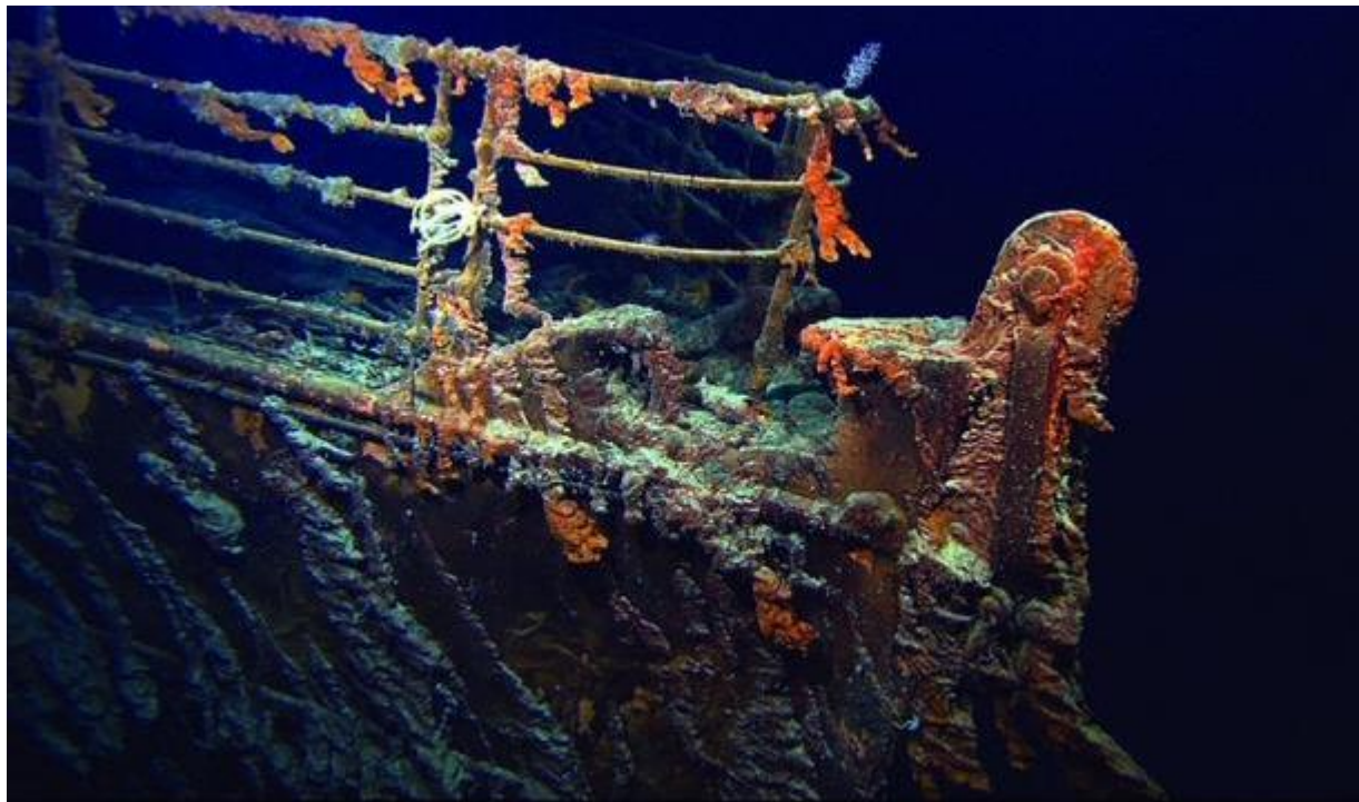
Slika 5.17. Biološka korozija – Titanik [38]
