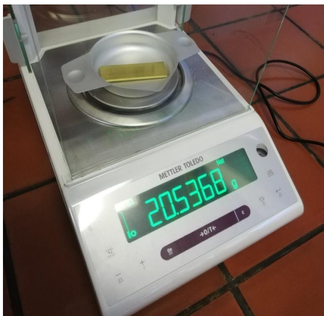
Slika 6.9. Vaganje ispitnih uzoraka - mjed
