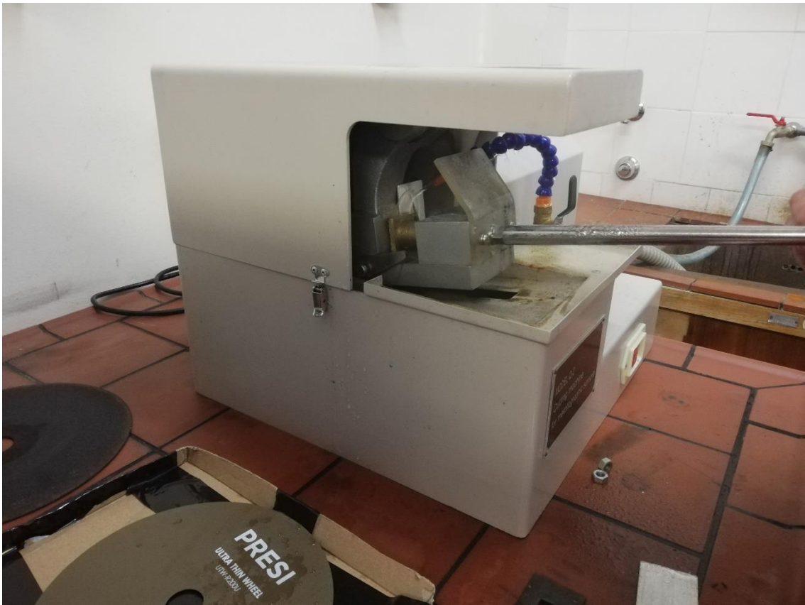
Slika 6.7. Izrezivanje ispitnih uzoraka od aluminija
