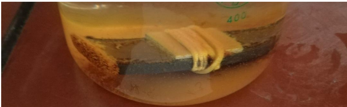
Slika 6.23. Kombinacija aluminijska i čelika u slatkoj vodi u omjeru 1:3 (uzorak 15) – drugi pregled
