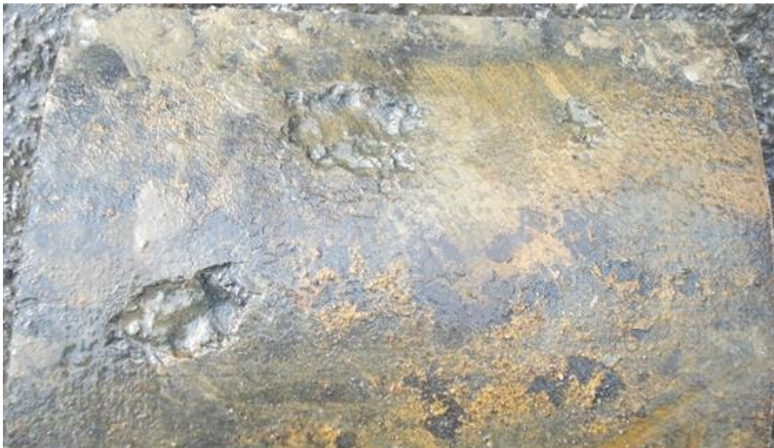
Slika 5.8. Grafitizacija sivog lijeva [30]
