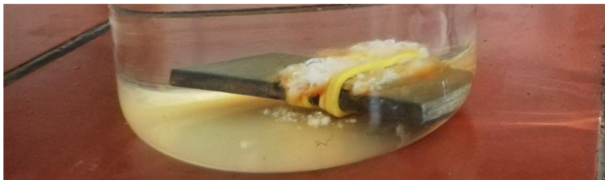
Slika 6.20. Kombinacija aluminija i čelika u morskoj vodi u omjeru 1:3 (uzorak 17) – prvi pregled
