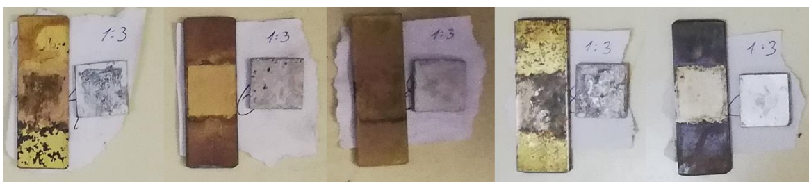
Slika 6.43. Izgled ispitnih uzoraka u ovisnosti o vrsti medija: 14 (zemlja), 16 (slatka voda), 18 (morska voda), 28 (zemlja (R)) i 30 (slatka voda (R)). Omjer površina aluminija i mjedi 1:3
