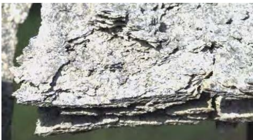
Slika 5.11. Eksfolijacija aluminijske legure [4]
