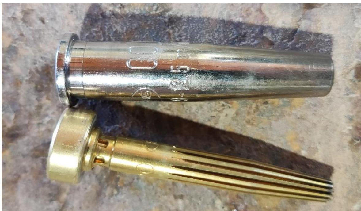
Slika 7.12. Mlaznica i elektroda (plinski gorionik)
