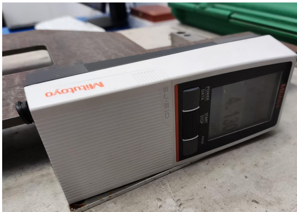
Slika 7.32. Mjerenje hrapavosti na dužini „A“ (AWJM)
