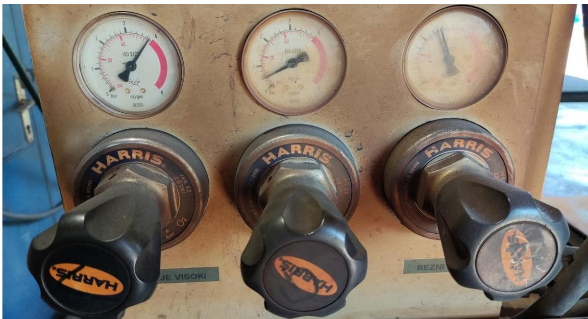
Slika 7.15. Namještavanje tlakova za grijanje i rezanje
