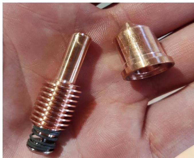
*Slika 7.2. Mlaznica i elektroda (PBM)*
