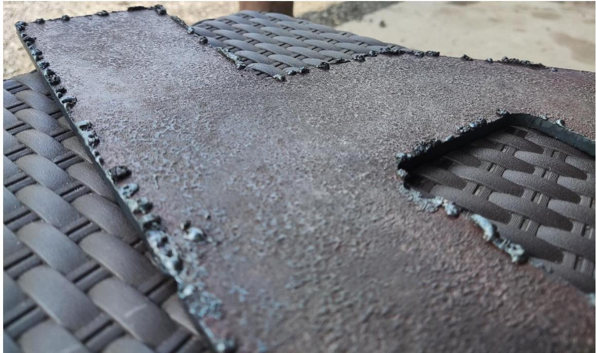
Slika 7.18. Izgled odrezne površine (plinsko rezanje)
