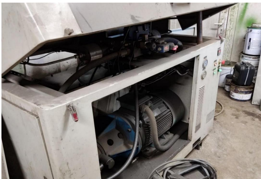
*Slika 7.25. Visokotlačna pumpa*
