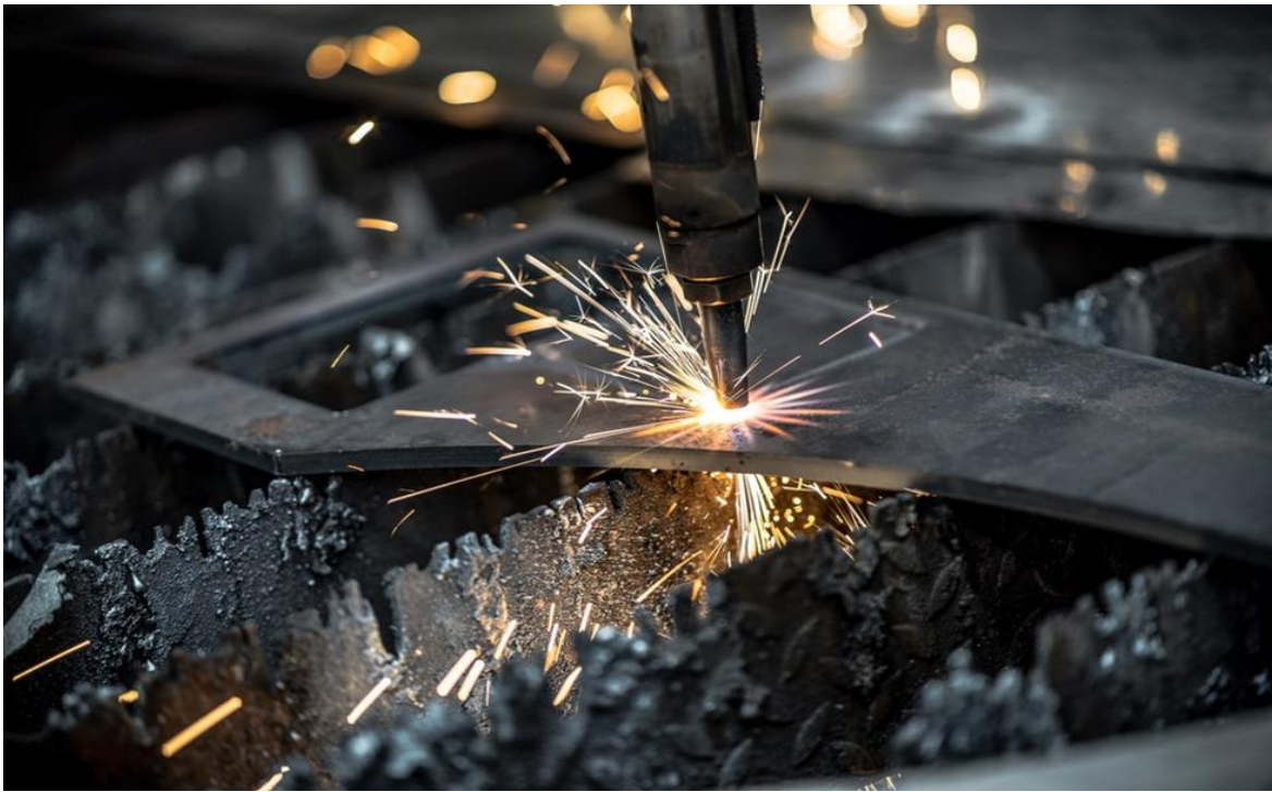
Slika 4.3. Rezanje metala plazma lukom [11]
