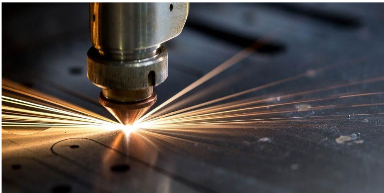
Slika 4.2. Obrada mlazom plazme (PBM) [8]
