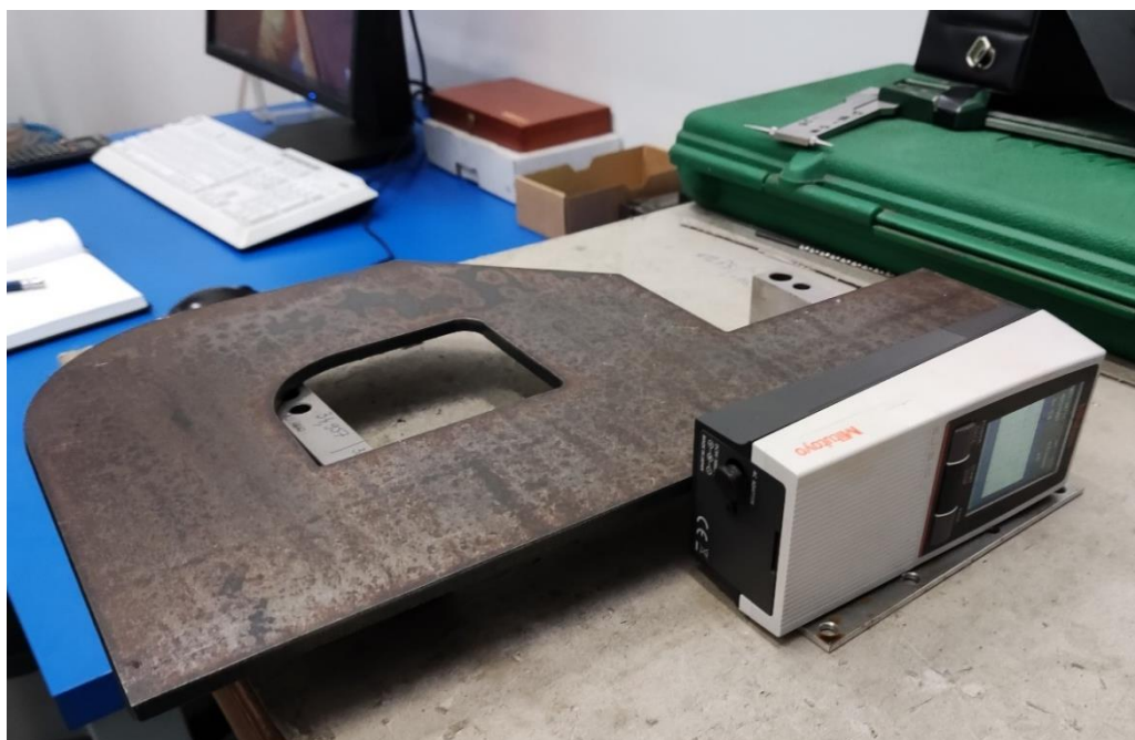
Slika 7.11. Mjerenje hrapavosti na dužini „A“ (PBM)
