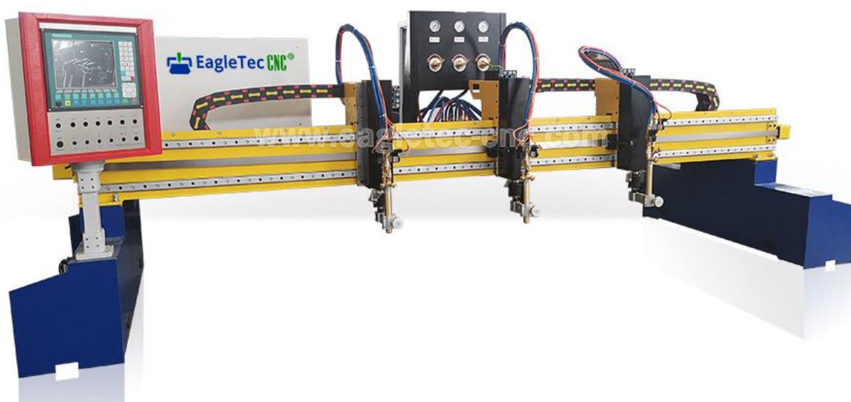
Slika 5.6. Automatiziran način rada s više mlaznica [22]
