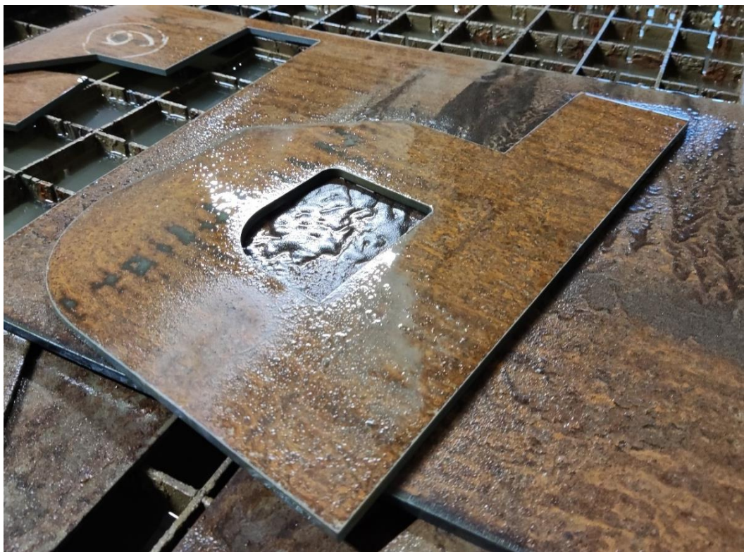
Slika 7.31. Odrezani testni uzorak (AWJM)
