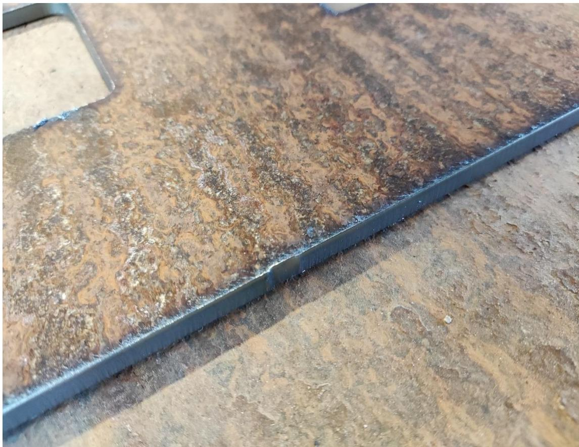
Slika 7.9. Prikaz odrezne površine (PBM)
