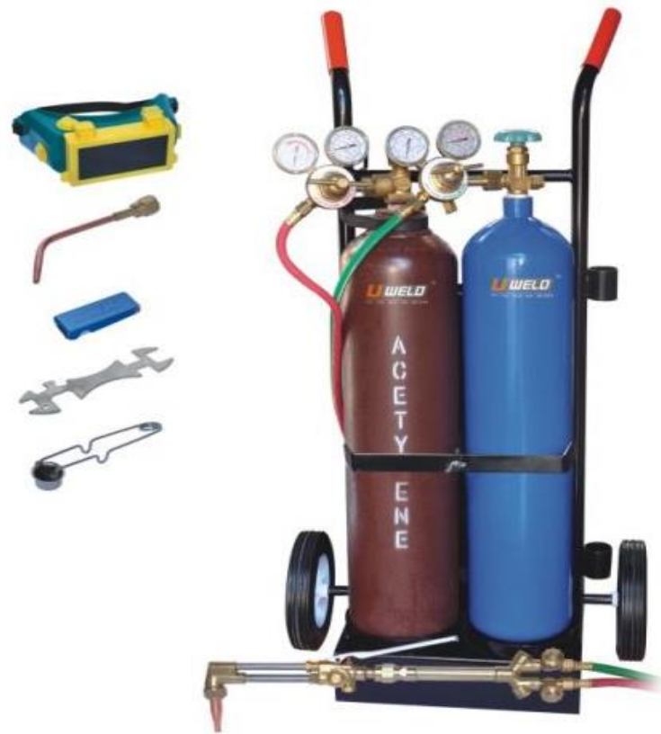
Slika 5.3. Oprema za ručno plinsko rezanje [19]
