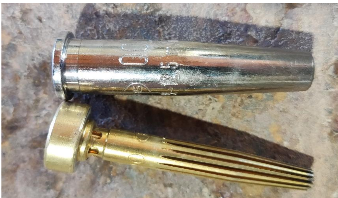
Slika 7.12. Mlaznica i elektroda (plinski gorionik)
