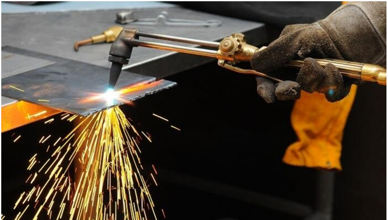
Slika 5.4. Ručno plinsko rezanje [20]
