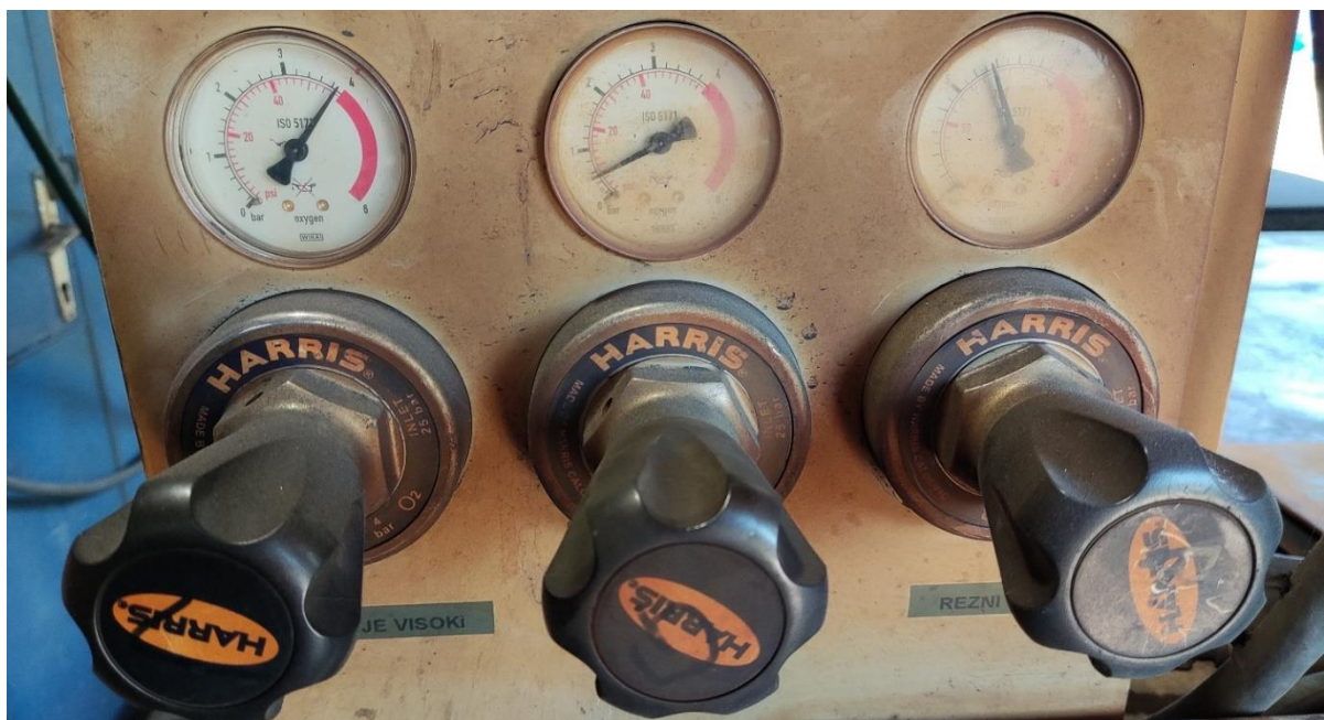
Slika 7.15. Namještavanje tlakova za grijanje i rezanje
