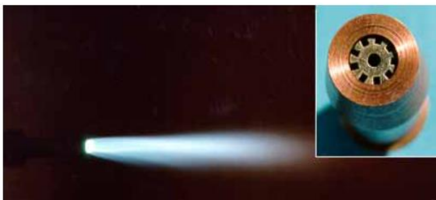
Slika 5.8. Dizajn mlaznice i propan plinski mlaz [16]
