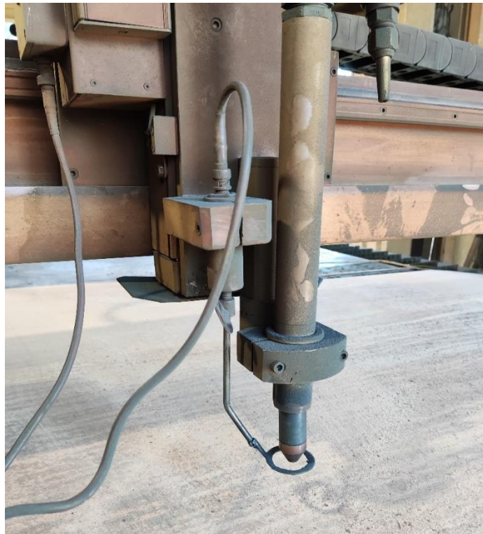
Slika 7.3. Spajanje plazmenog gorionika
