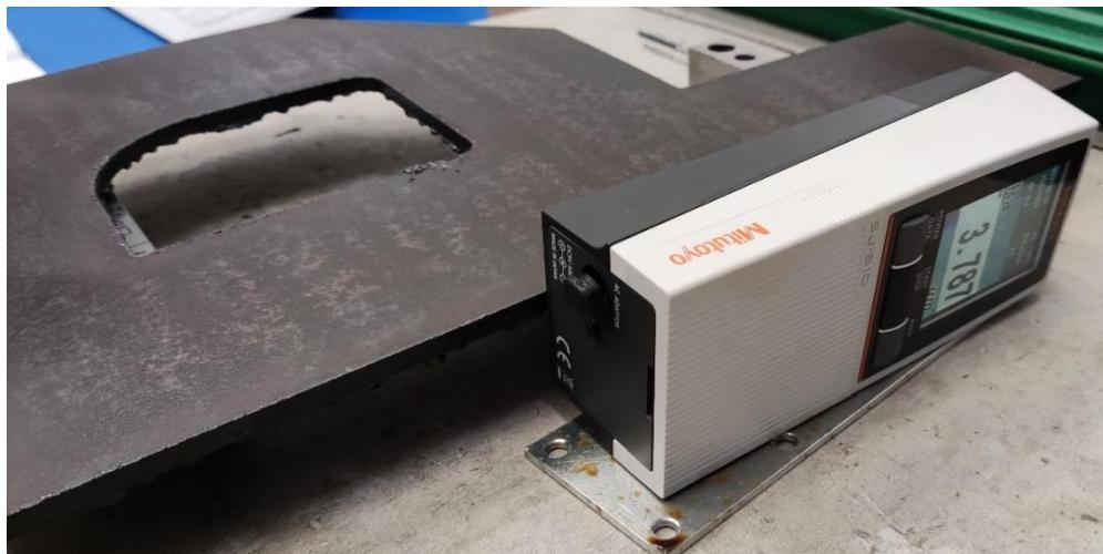
Slika 7.19. Mjerenje hrapavosti na dužini „A“ (plinsko rezanje)
