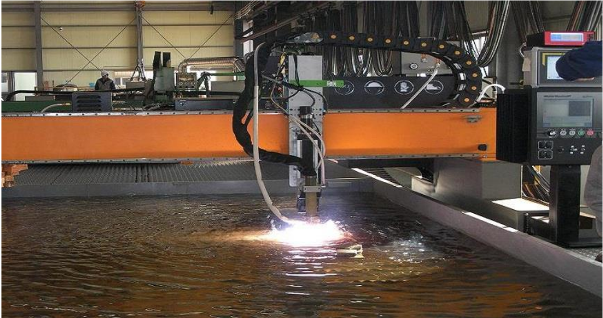
Slika 4.8. Podvodno plazma rezanje [10]
