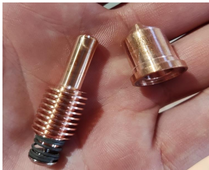
Slika 7.2. Mlaznica i elektroda (PBM)
