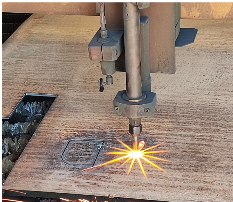
Slika 7.16. Plinsko rezanje testnog uzorka
