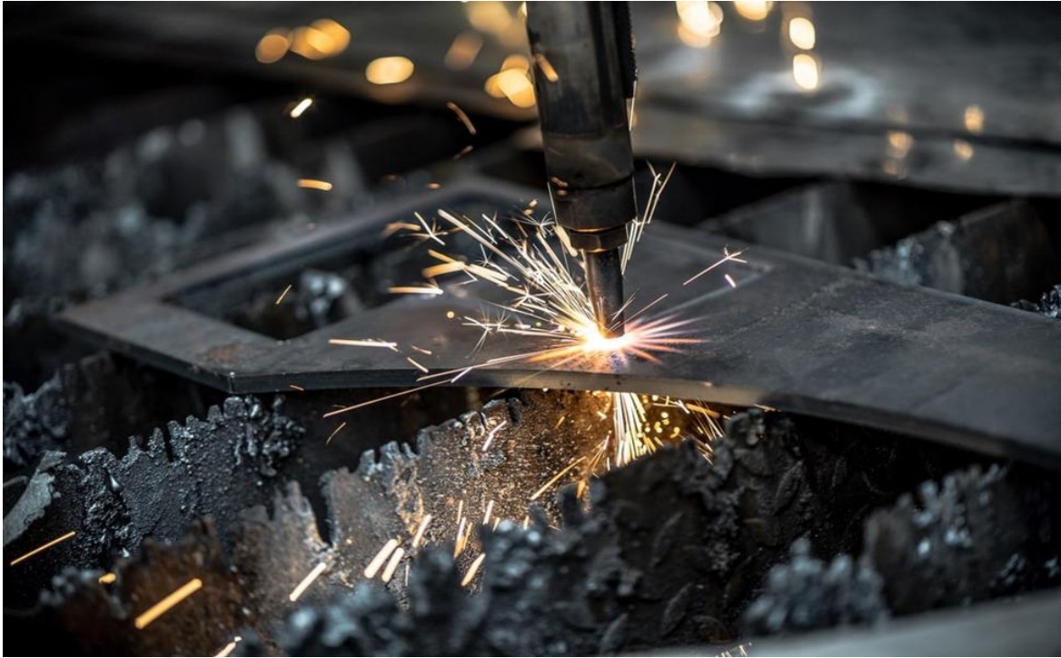
Slika 4.3. Rezanje metala plazma lukom [11]
