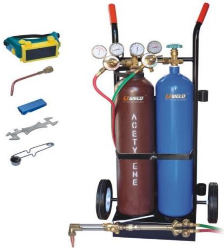
Slika 5.3. Oprema za ručno plinsko rezanje [19]
