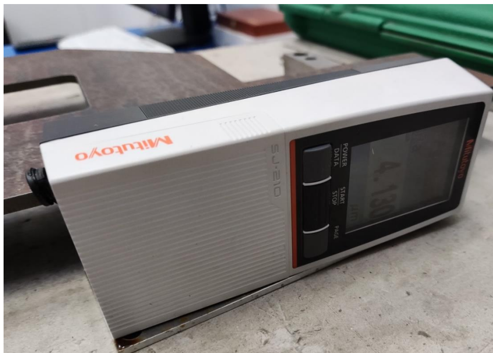
Slika 7.32. Mjerenje hrapavosti na dužini „A“ (AWJM)
