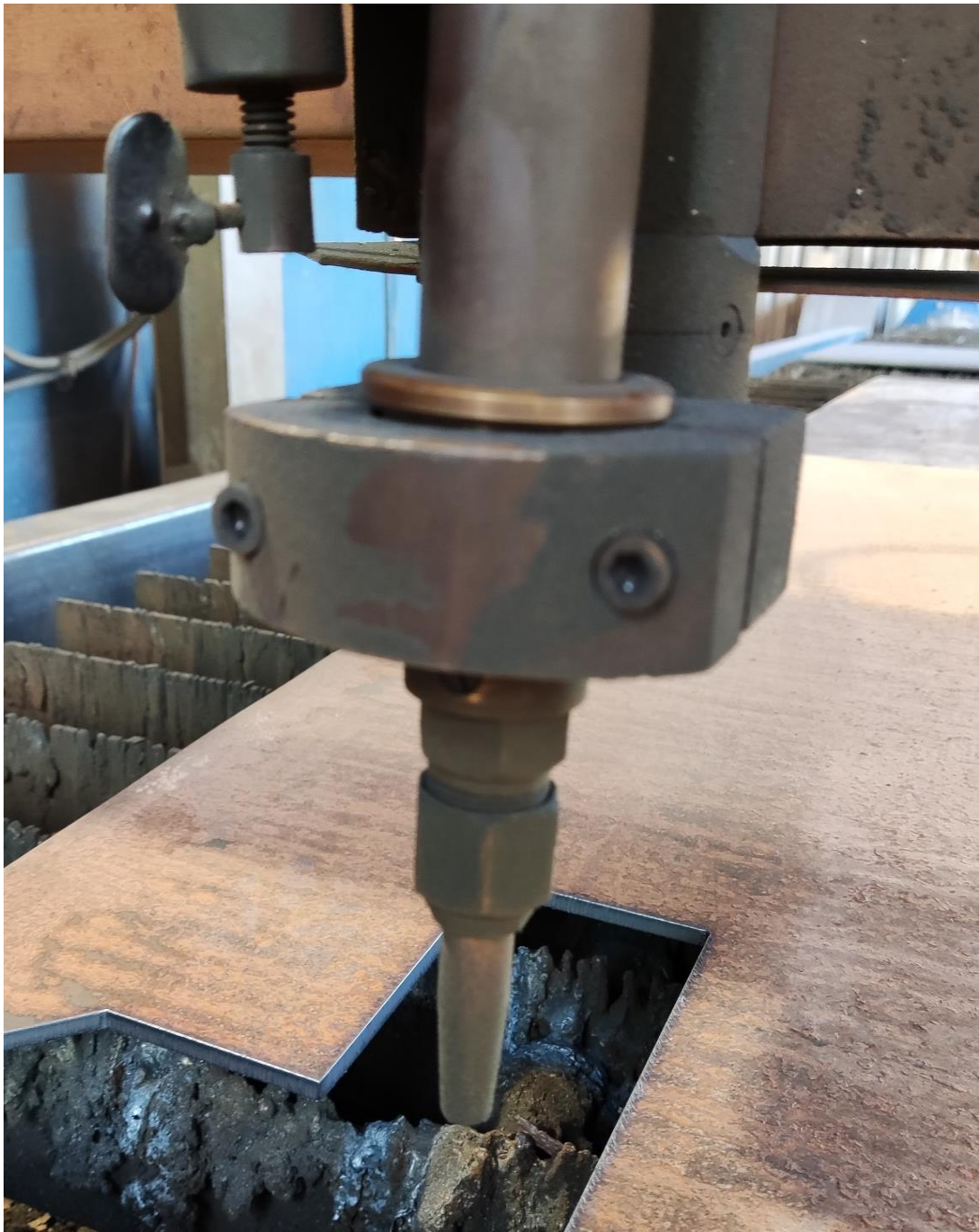
Slika 7.13. Postavljanje plinskog gorionika
