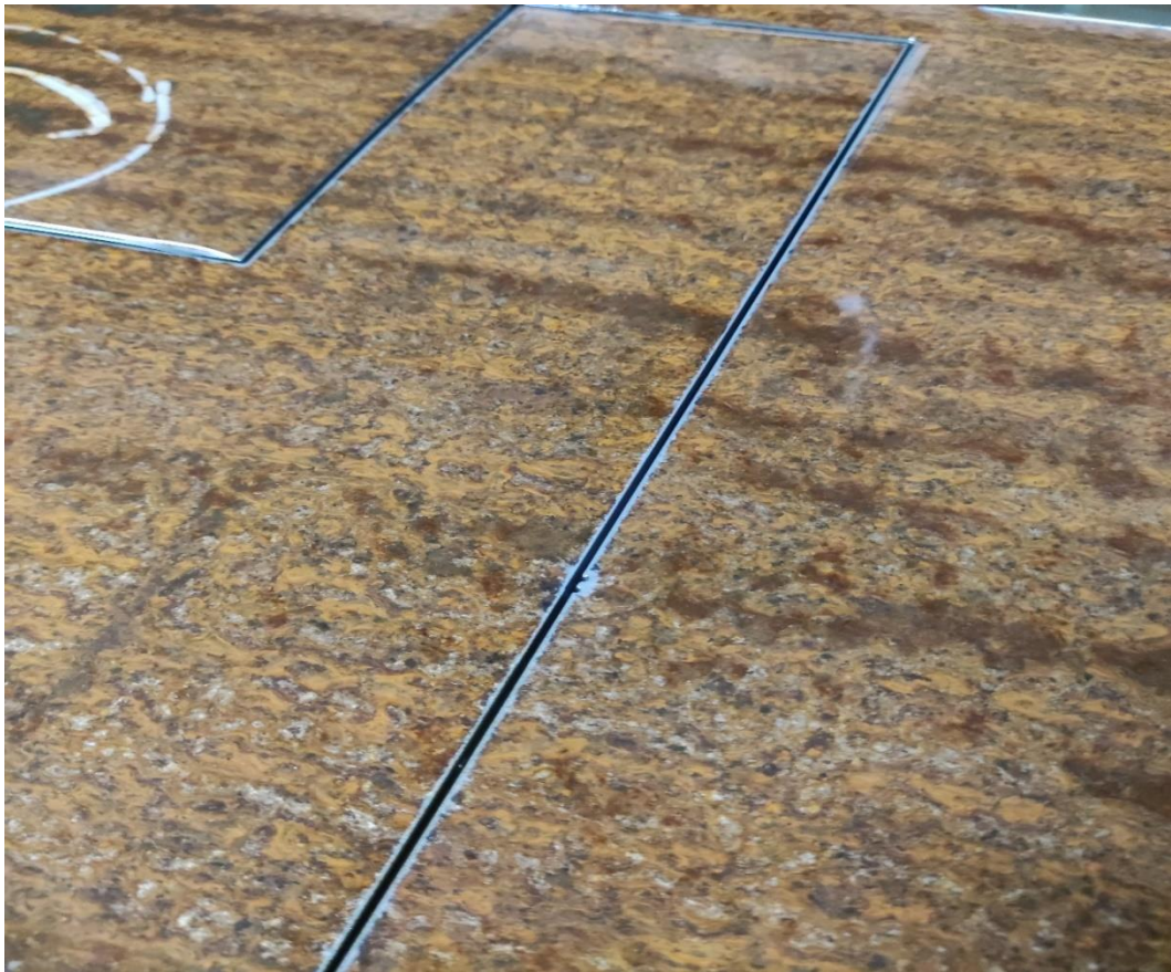
Slika 7.30. Prikaz reza (ulaz i izlaz abrazivnog vodenog mlaza)
