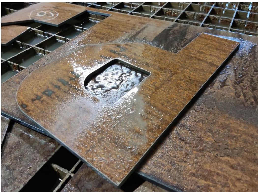
Slika 7.31. Odrezani testni uzorak (AWJM)
