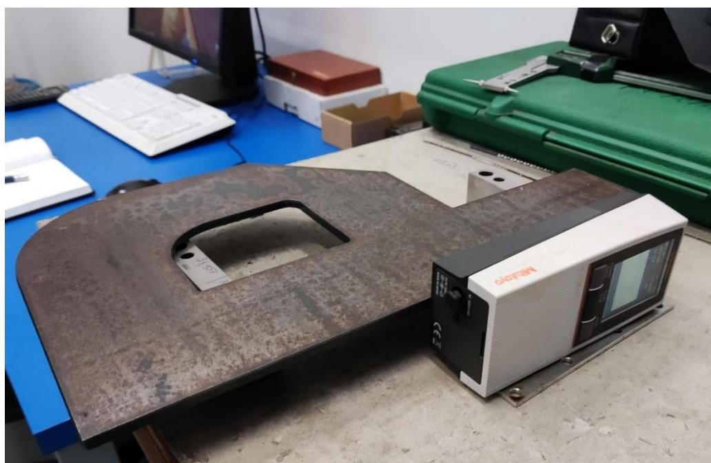
Slika 7.11. Mjerenje hrapavosti na dužini „A“ (PBM)
