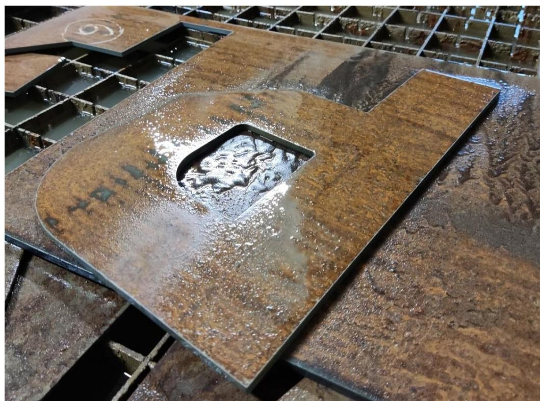
Slika 7.31. Odrezani testni uzorak (AWJM)
