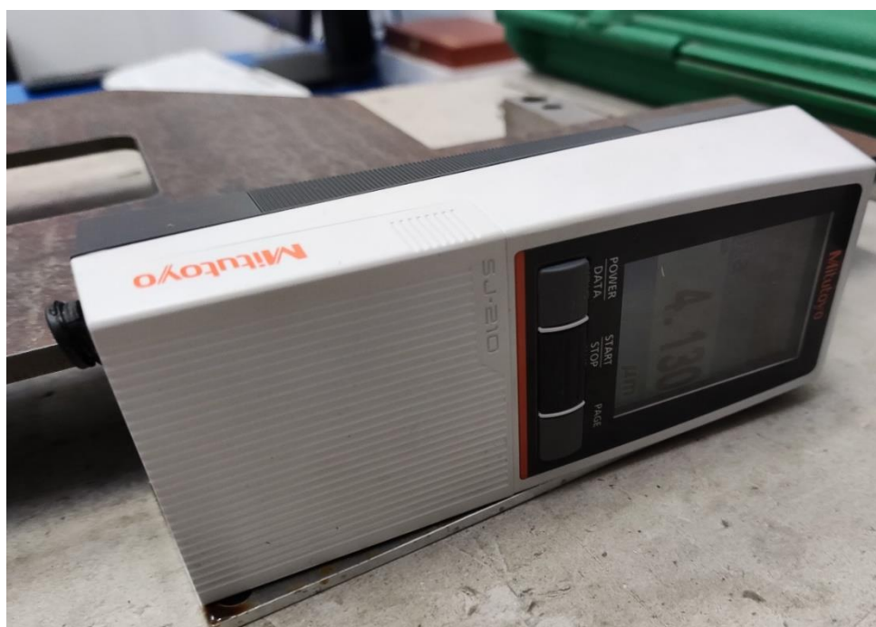
Slika 7.32. Mjerenje hrapavosti na dužini „A“ (AWJM)
