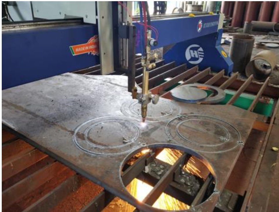
Slika 5.5. Automatizirano plinsko rezanje [21]
