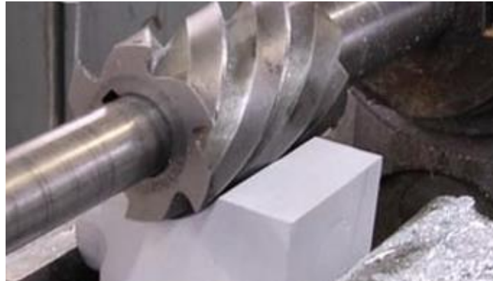
Slika 3.6. Obimno ravno glodanje [3]
