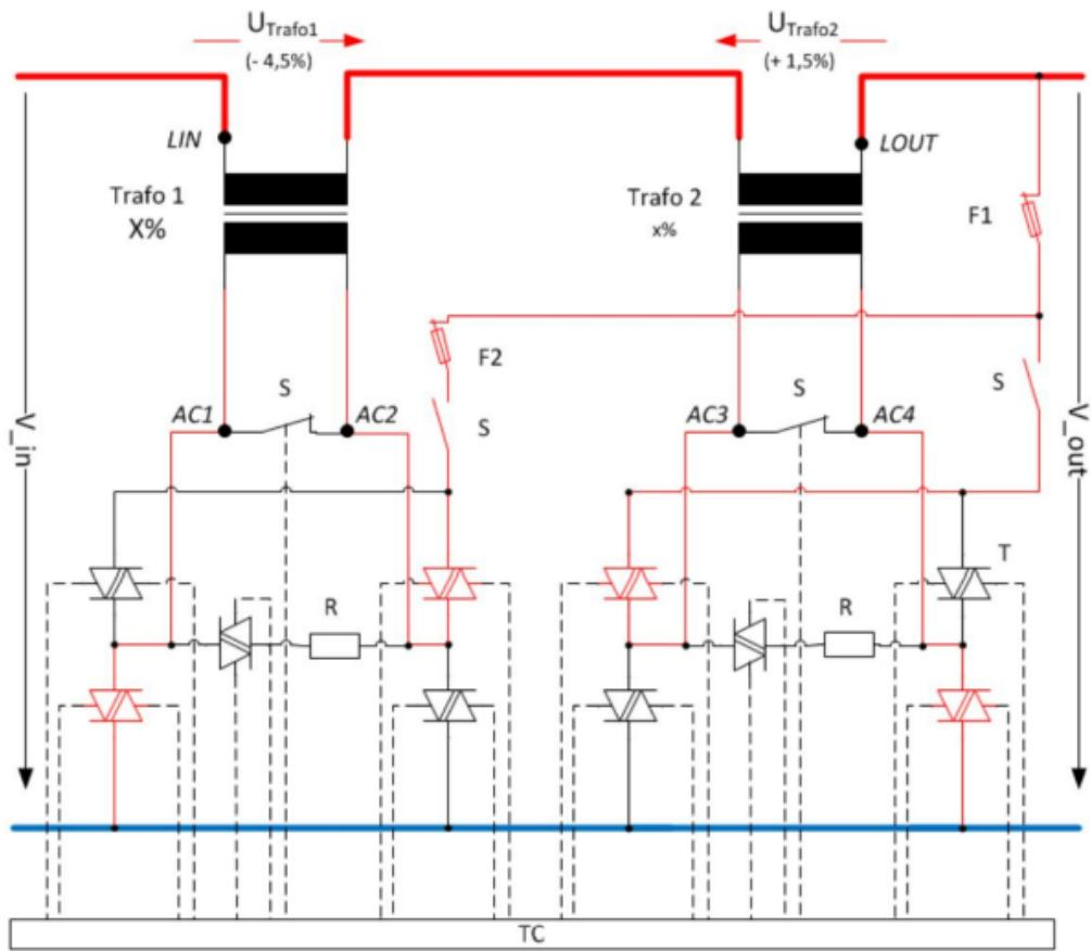
Slika 8.4. Princip rada LVR Sys sustava [23]
