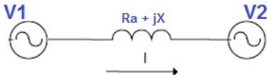
Slika 5.2. Osnovni princip rada D-STATCOM-a [19]
