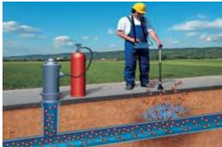
Slika 5.1. Traženje šumova kod istjecanje vode iz cijevi vodovodne mreže
