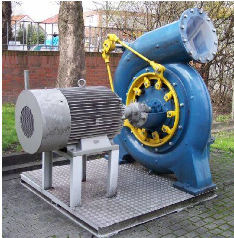
Slika 3.5. Francis-ova turbina spojena na električni generator [6]
