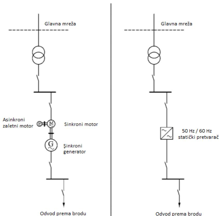
Slika 3.1 Rotirajući (lijevo) i statički (desno) frekvencijski pretvarači [8]
