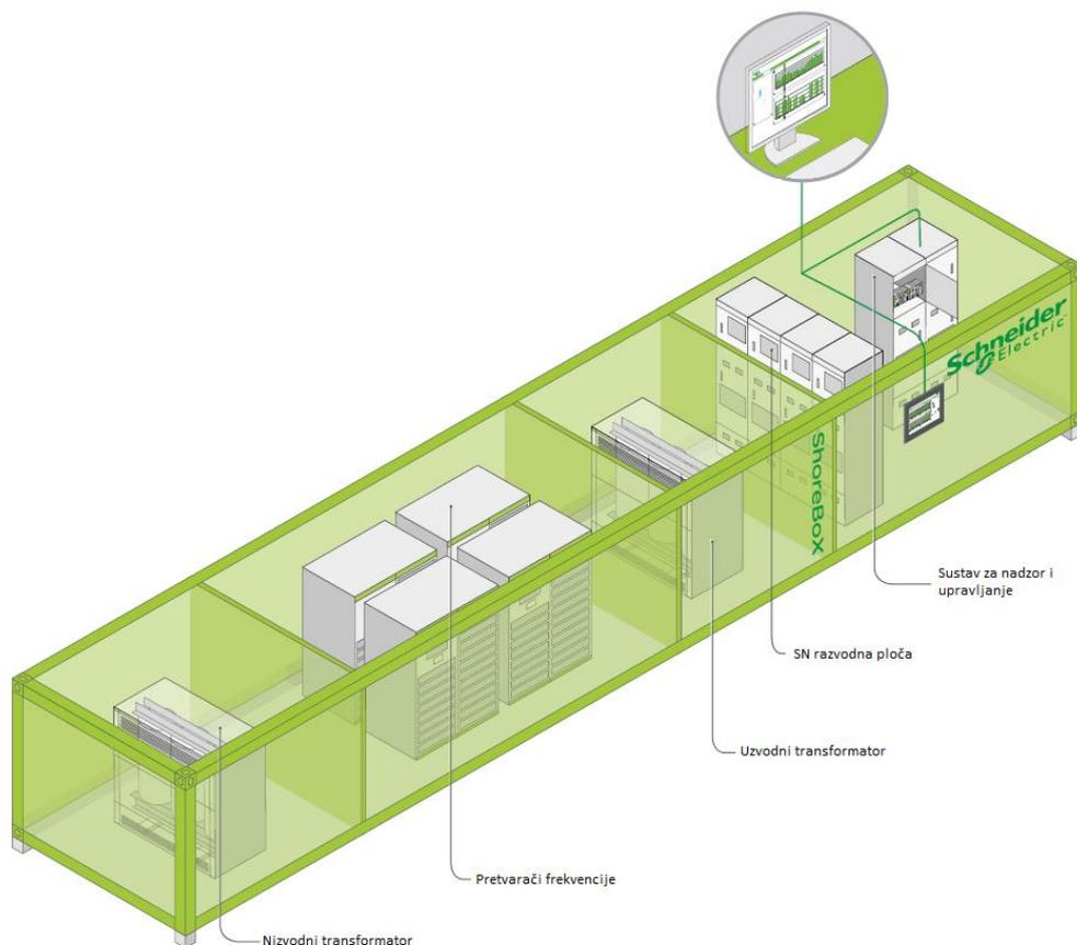
Slika 4.5 Prikaz jedinica unutar ShoreBoX sustava [17]
