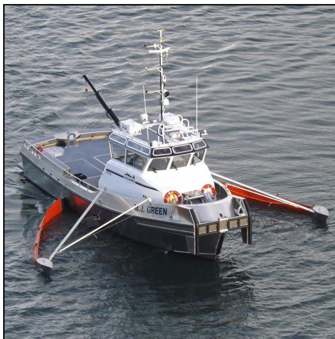
Slika 6.2. Sakupljač ulja (Skimmer recovery boat)[31]
