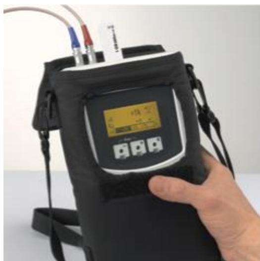
Slika 4.4. Putno računalo korištenog ultrazvučnog mjerača [9]
