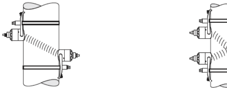
Slika 4.2. Mogući načini montiranja senzora kod ove vrste ultrazvučnog mjerača [9]
