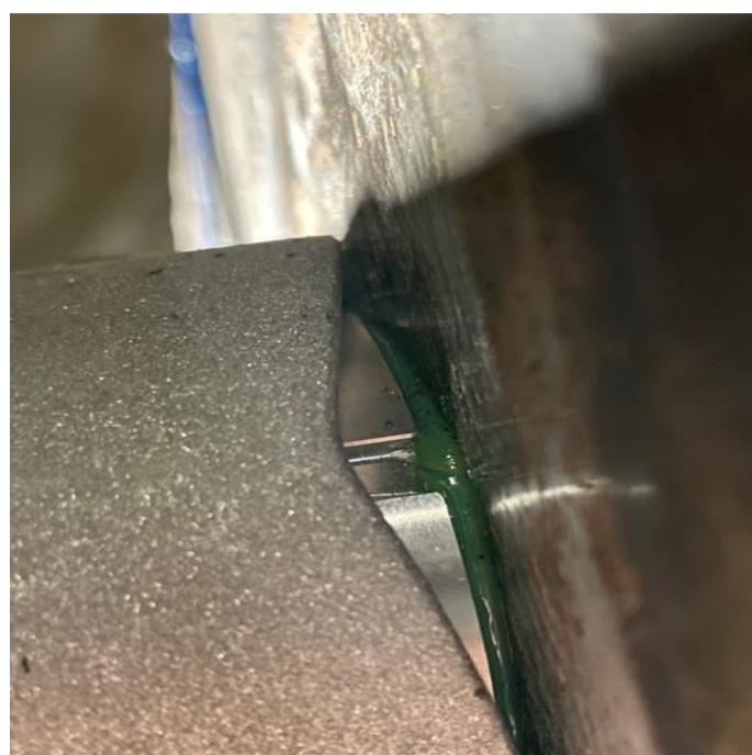
Slika 4.10. Pasta na ultrazvučnom mjeraču
