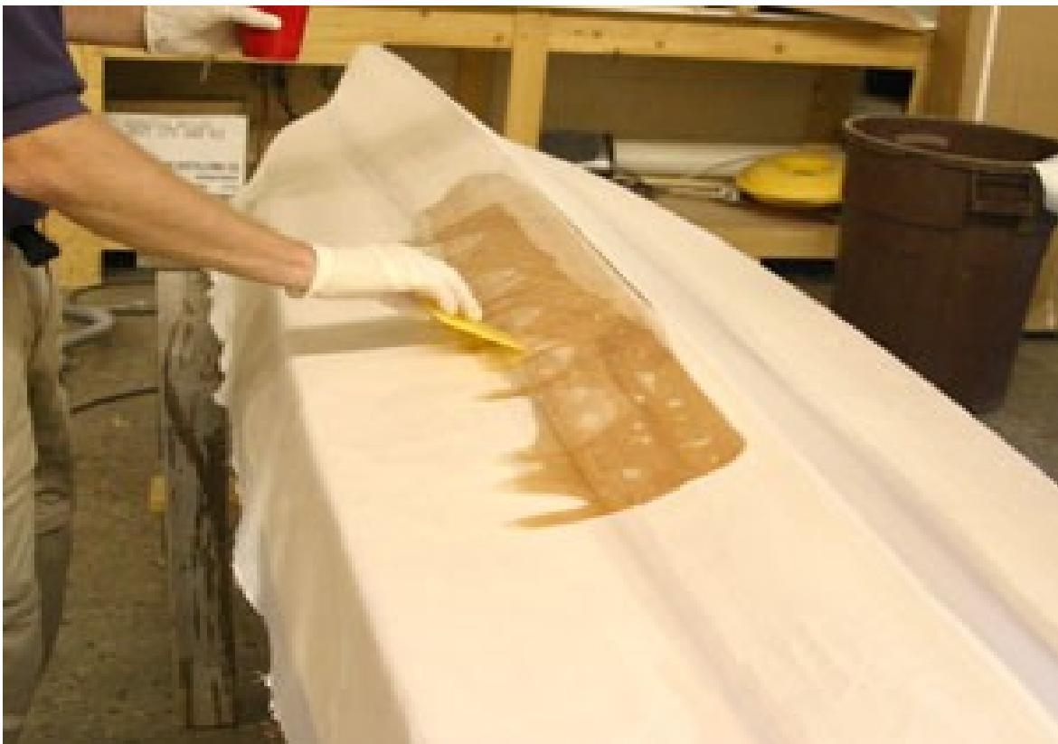
*Slika 3.8. Raspršivanje epoksidne smjese po površini tkanine [19]*
