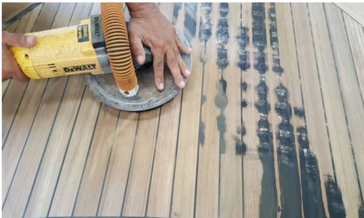
Slika 2.11. Brušenje palube brusilicom [12]
