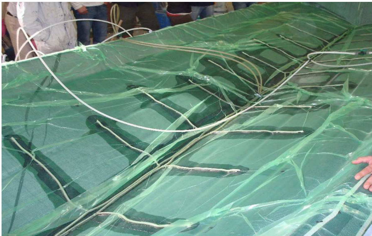
Slika 3.12. Stvaranje vakuuma i uvođenje smole [23]
