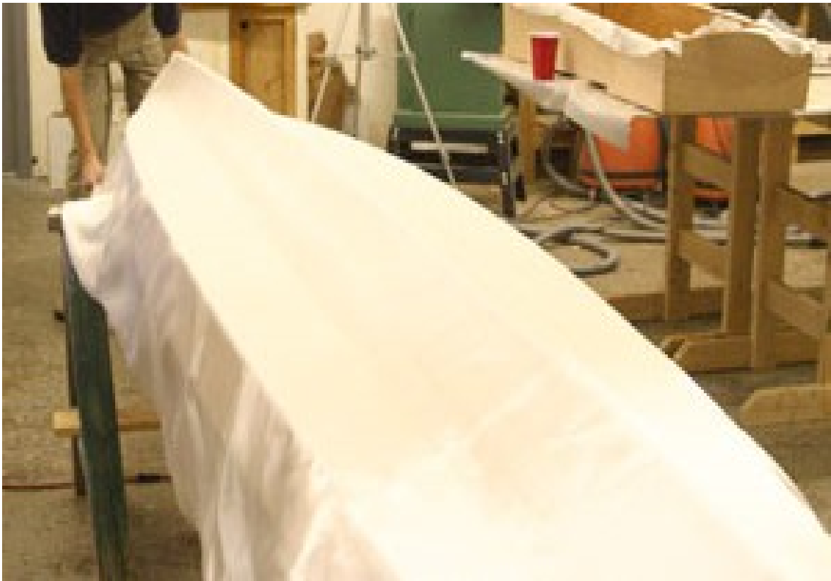
Slika 3.7. Postavljanje tkanine od stakloplastike „suhom“ metodom [19]
