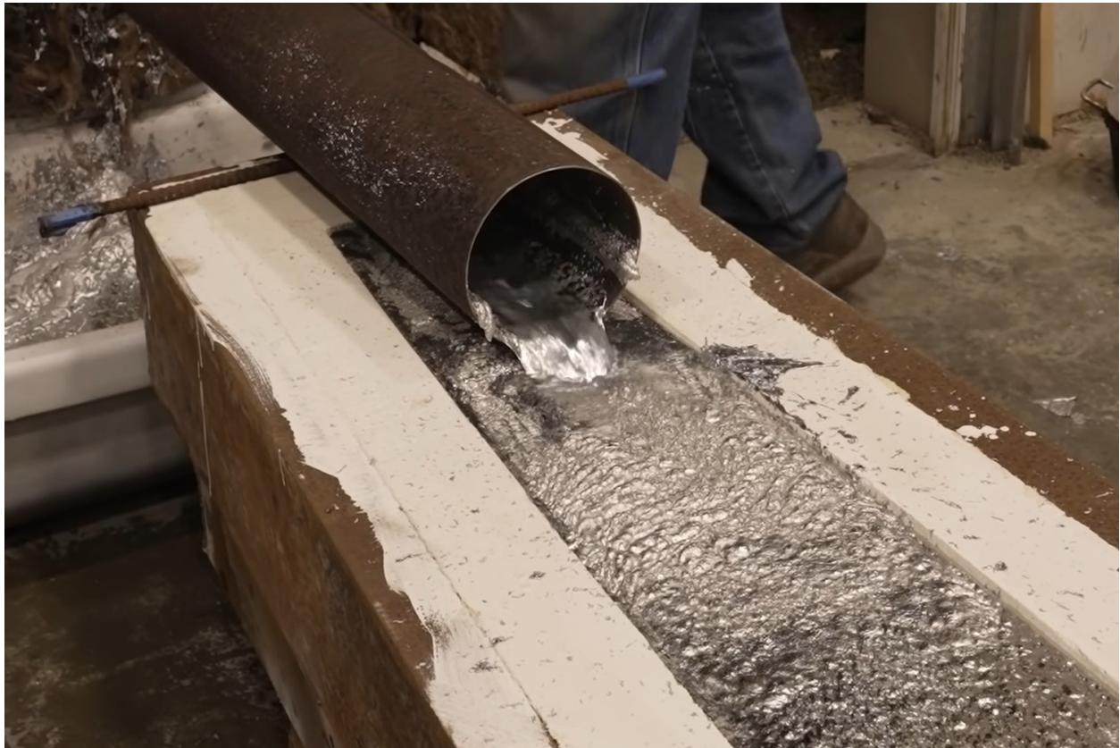
*Slika 4.2. Izrada olovnog balasta [25]*
