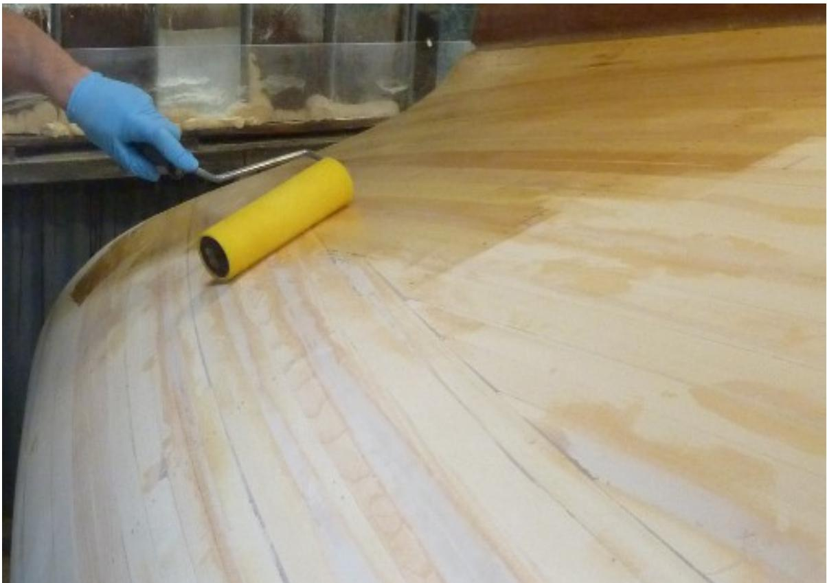
*Slika 3.3. Zaštita vanjske oplate epoksidnom smolom [17]*
