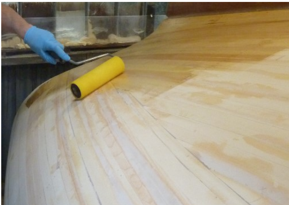
Slika 3.3. Zaštita vanjske oplata epoksidnom smolom [17]
