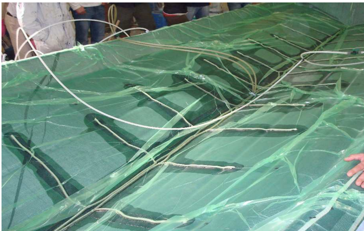
Slika 3.12. Stvaranje vakuuma i uvođenje smole [23]
