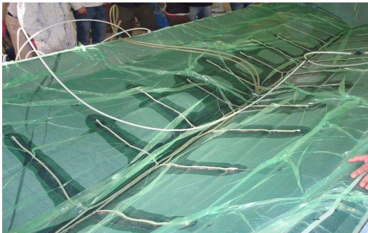
Slika 3.12. Stvaranje vakuuma i uvođenje smole [23]
