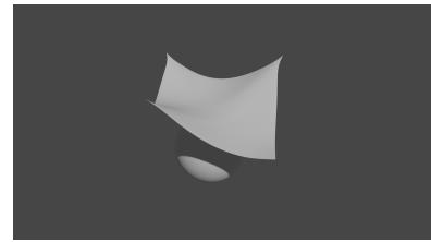
Slika 5.5 Prikaz simulacije sudara sa sferom sa pridodanim oprugama smicanja u model
