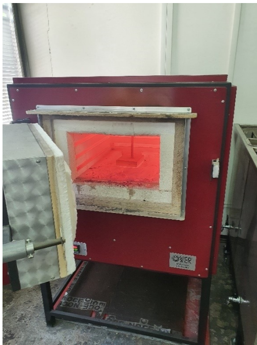
Slika 7.9. Strojni dio unutar elektro peći (tip „OVER“)
