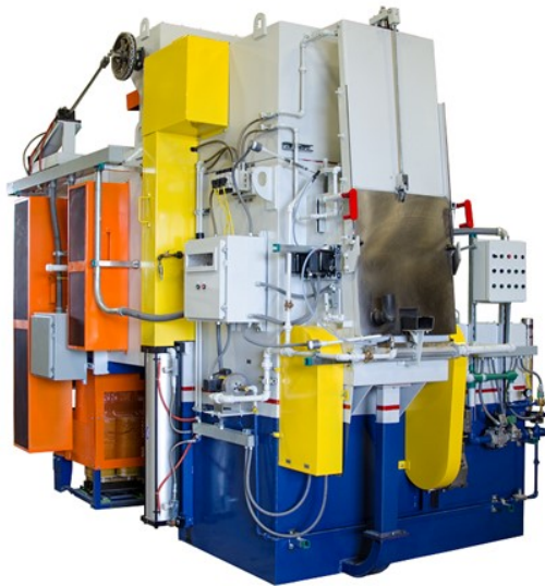
Slika 6.2. Integrirana peć sa košarom za gašenje (eng. Integral Quench Furnace) [14]
