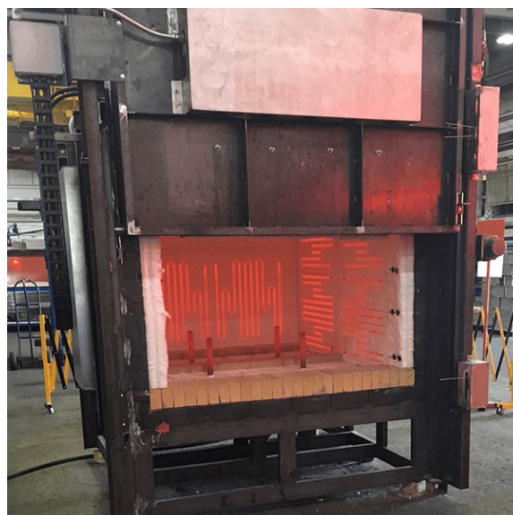
Slika 6.1. Peć u obliku kutije (eng. Box Furnace) [13]
