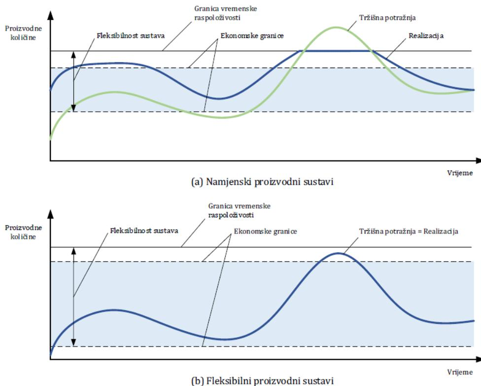
Slika 2.3. Tipovi proizvodnih sustava ovisno o količinskoj promjenjivosti [1]
