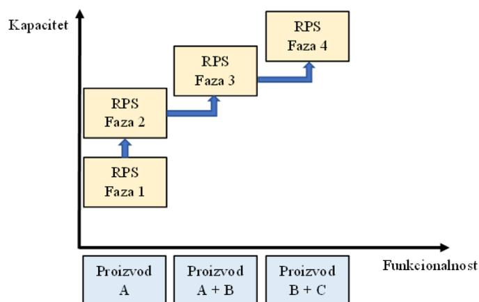
Slika 2.10. Princip povećanja kapaciteta i funkcionalnosti rekonfigurabilnog sustava [6]
