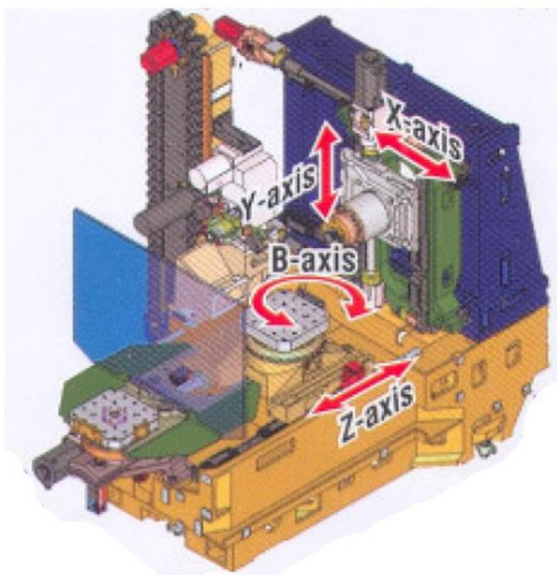
Slika 5.6. Prikaz 4 osi kod horizontalnog glodaćeg obradnog centra [20]
