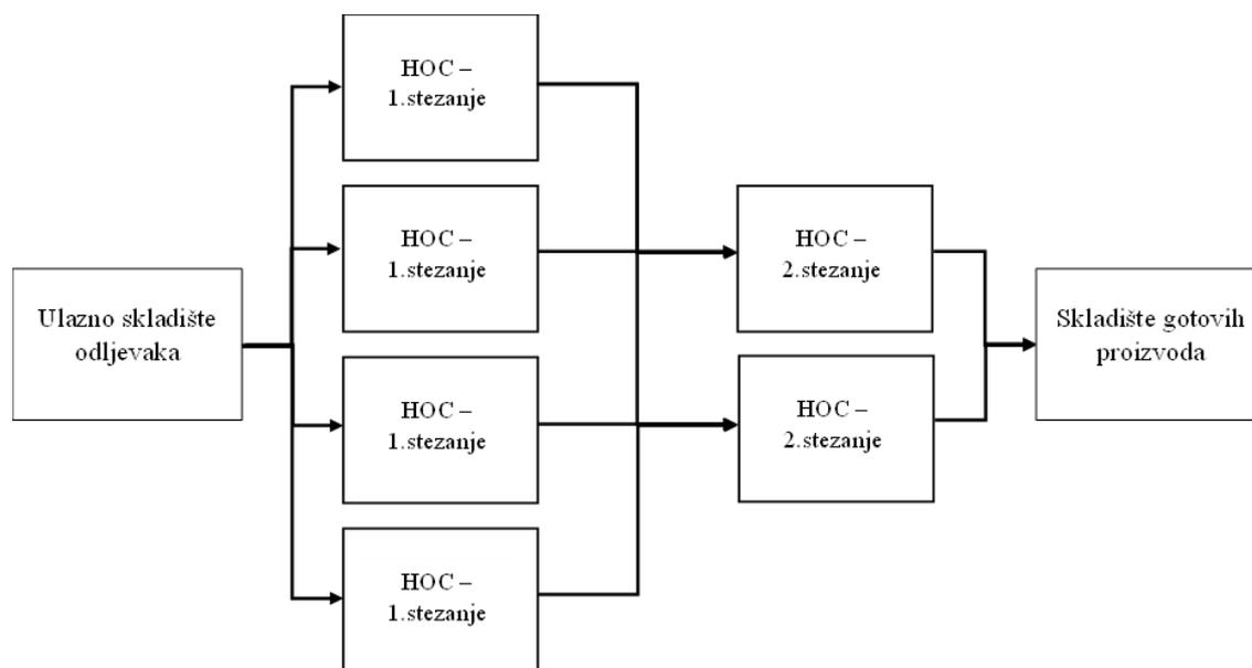
Slika 5.29. Grubi prostorni raspored procesa strojne obrade
