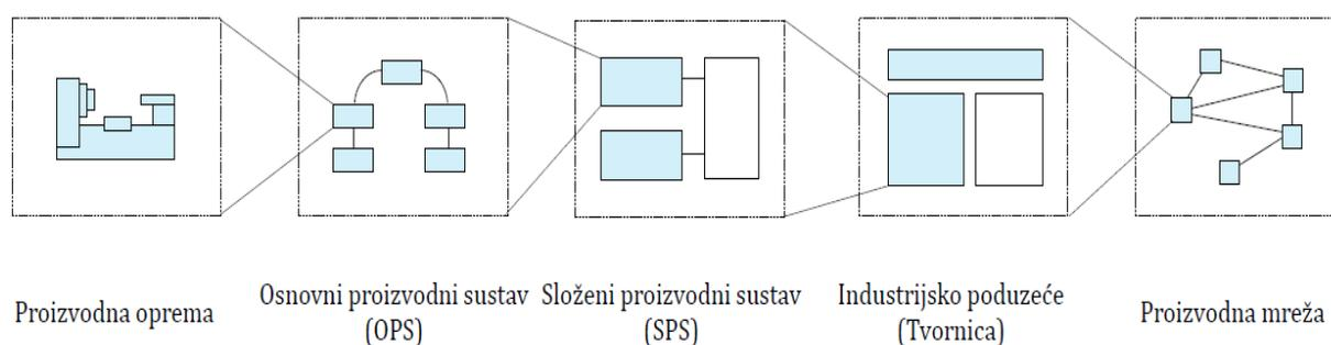
Slika 2.1. Podjela proizvodnog sustava unutar poslovnog sustava [1]
