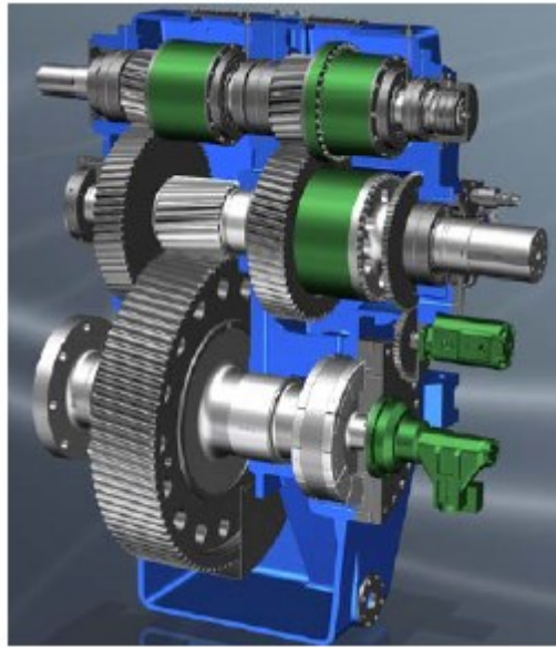
Slika 1.1 Primjer dvostupanjskog reduktora
