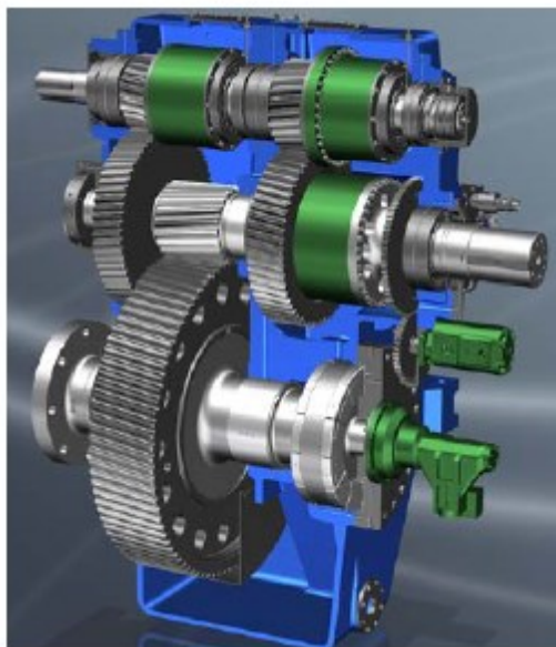
Slika 1.1 Primjer dvostupanjskog reduktora
