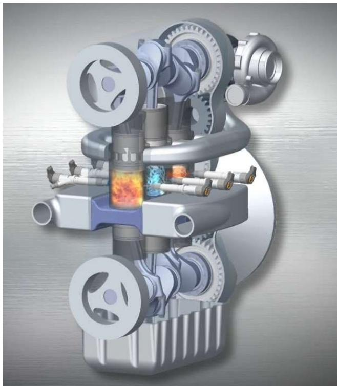
Slika 3.2 Pojednostavljeni prikaz Achates motora s nasuprotnim klipovima [6]
