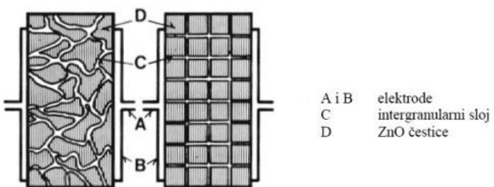
*Slika 3.3. Mikroskopska struktura varistora [1]*
