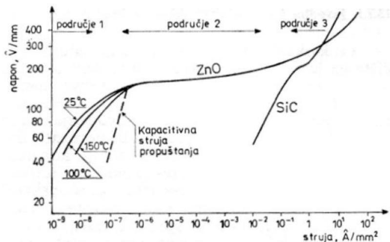
Slika 3.4. Strujno-naponska karakteristika MO odvodnika [1]
