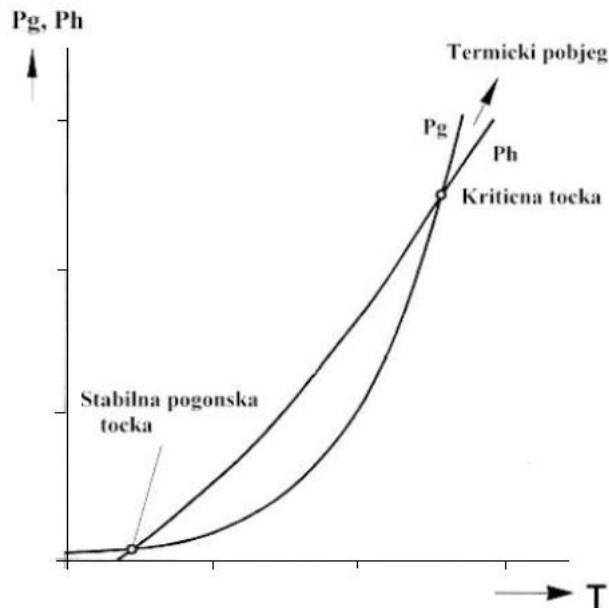
Slika 3.5. Zagrijavanje i hlađenje MO odvodnika prenapona [1]
