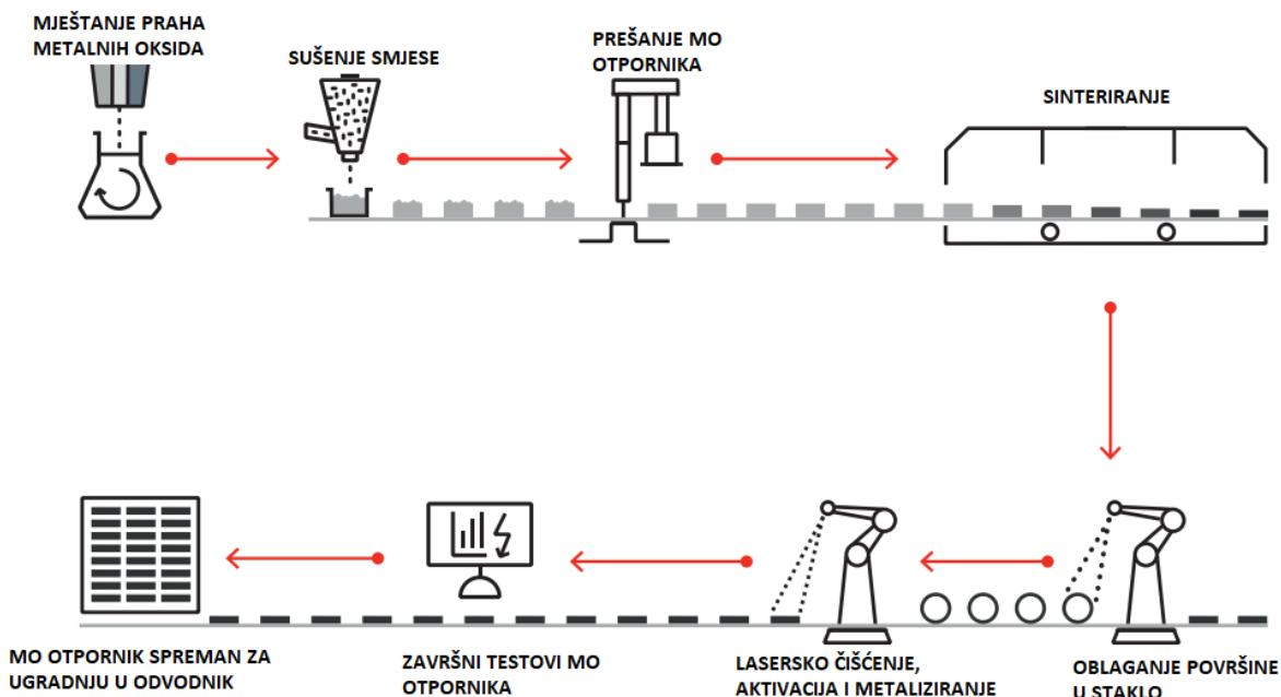
*Slika 3.2. Tehnološki proces dobivanja MO otpornika [9]*
