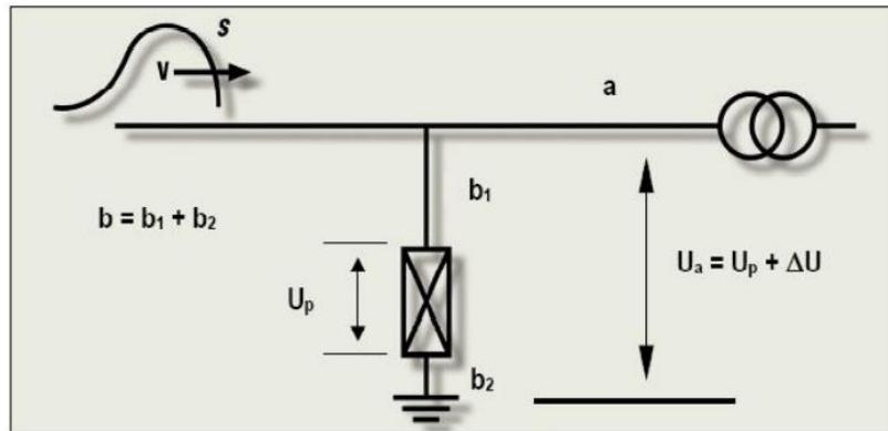
Slika 5.5. Shematski prikaz nailaska putujućeg napona na odvodnik [8]
