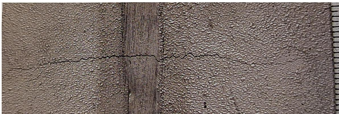
*Slika 3.2. Poprečna pukotina u zavaru, ZUT-u i osnovnom materijalu [5]*
