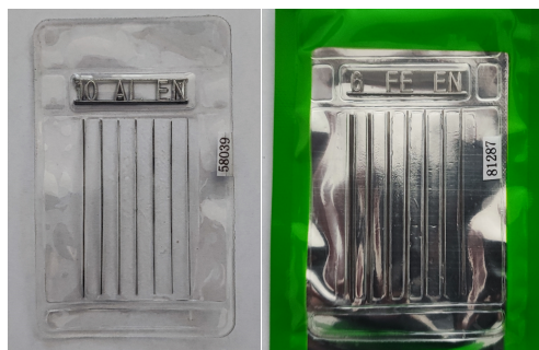
Slika 4.11. Indikatori kvalitete radiograma
