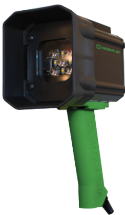
Slika 2.10. Prikaz UV lampe proizvođača Magnaflux [4]
