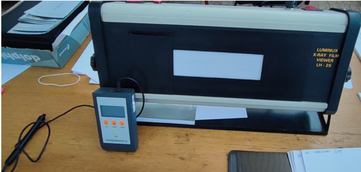
Slika 4.21. Iluminator i denzitometar
