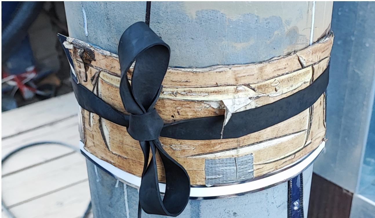
Slika 4.15. Postavljeni film na zavaru
