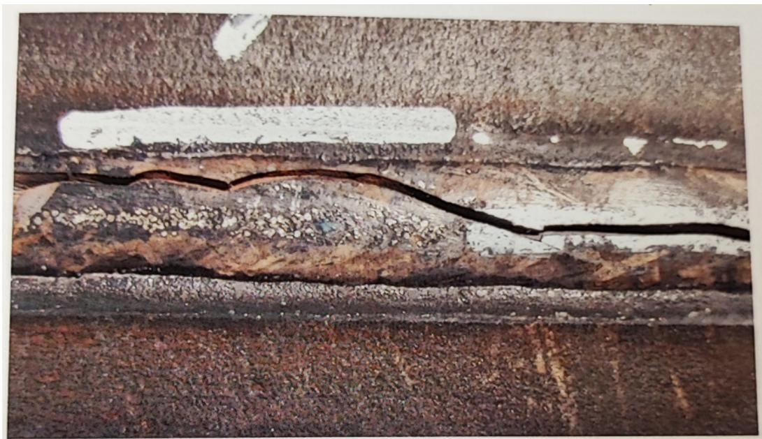
Slika 3.1. Uzdužna pukotina u sučeljenom zavarenom spoju [5]
