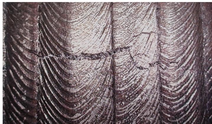
*Slika 3.5. Razgranata pukotina u zavaru martenzitnog čelika [5]*
