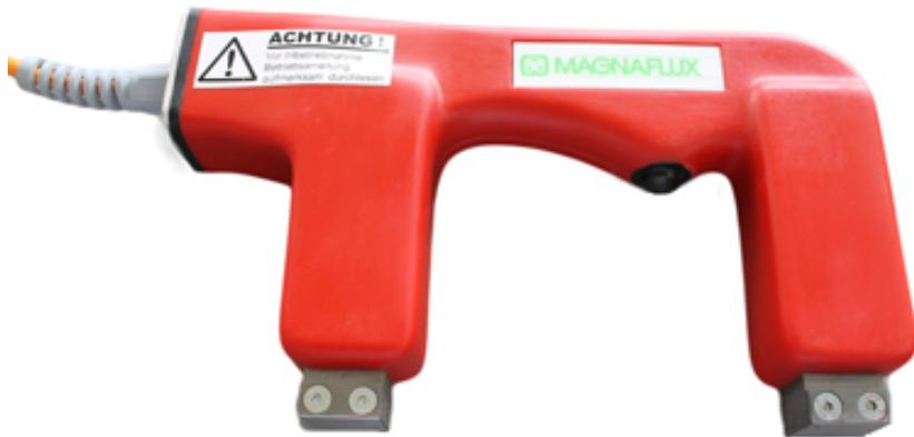
Slika 2.8. Prikaz elektromagnetskog jarma proizvođača Magnaflux [4]
