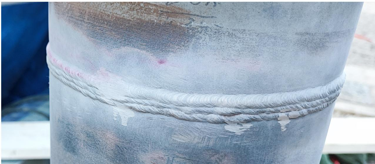
Slika 5.5. Razvijač nakon isteka vremena razvijanja sa prednje strane zavara
