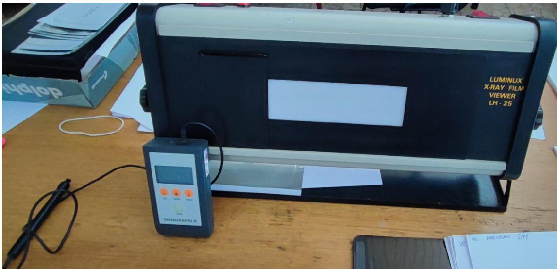
*Slika 4.21. Iluminator i denzitometar*
