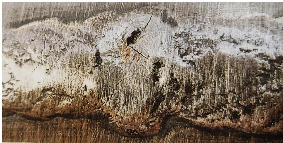
*Slika 3.3. Zvjezdasta pukotina u zavaru [5]*
