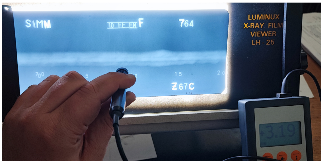
Slika 4.22. Provjera zacrtnjenja radiograma denzitometrom
