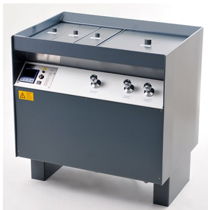
Slika 4.12. Kada za razvijanje filmova [8]
