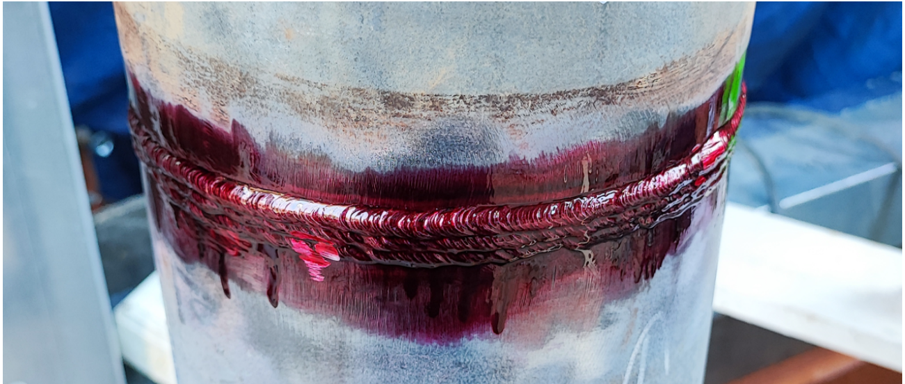
Slika 5.4. Prikaz nanesenog crvenog penetranta na zavar
