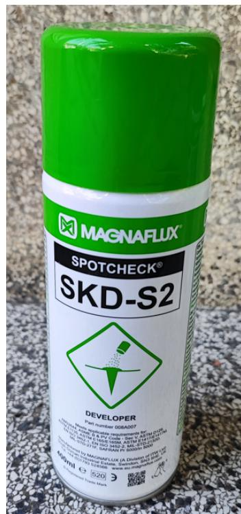
Slika 5.3. Razvijač oznake SKD-S2 korišten za ispitivanje
