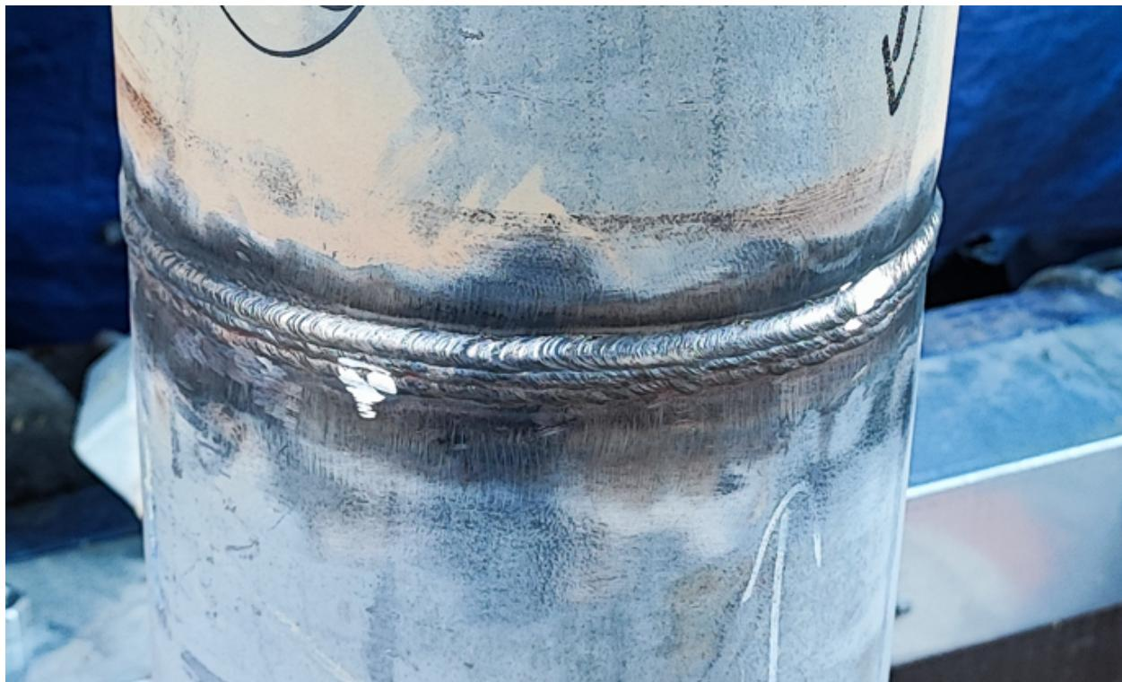
Slika 4.1. Prikaz zavarenog spoja strojnog dijela MS.20-DI.41
