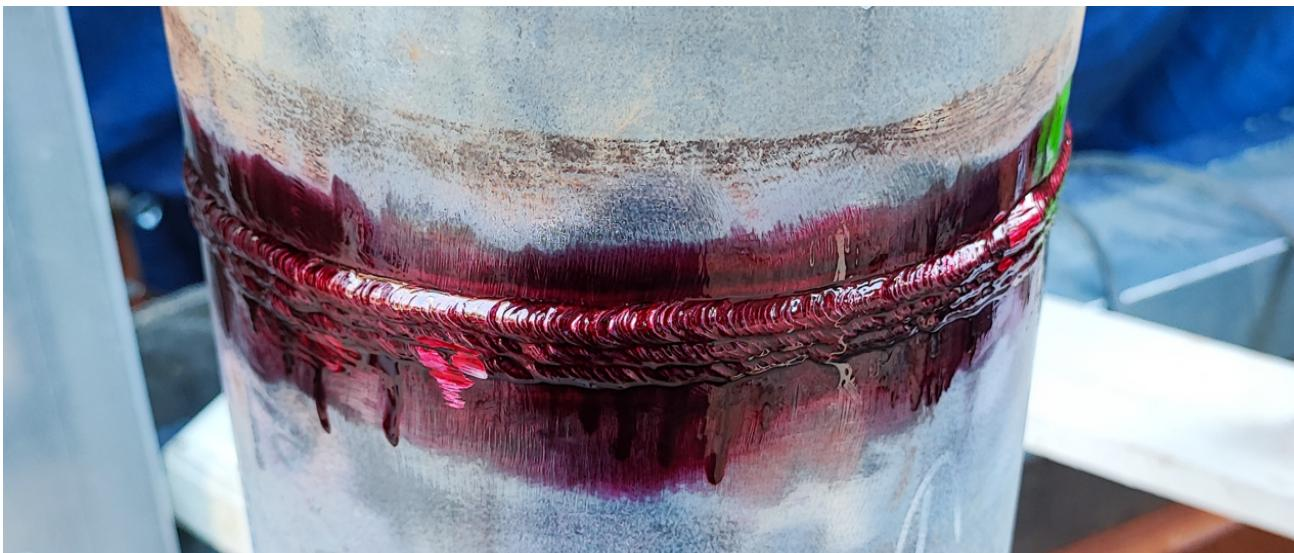
*Slika 5.4. Prikaz nanesenog crvenog penetranta na zavar*
