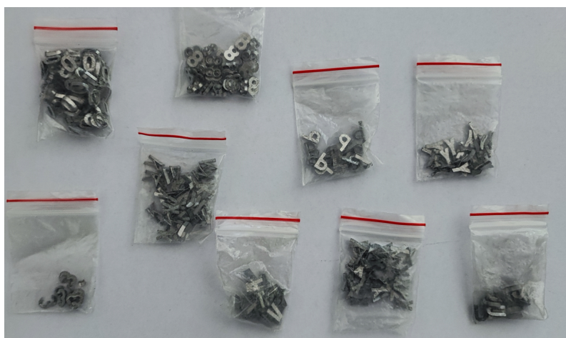
Slika 4.10. Olovna slova i brojevi za označavanje zavora
