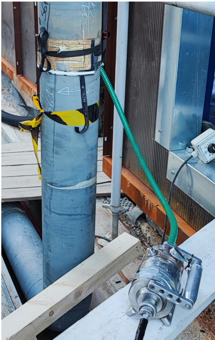
*Slika 4.18. Vodilica sa kolimatorom prislonjenim uz zavar*
