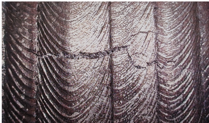
Slika 3.5. Razgranata pukotina u zavaru martenzitnog čelika [5]
