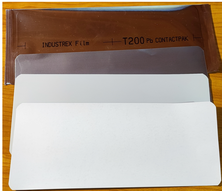
Slika 4.9. Neeksponirani film izvađen iz vakuum pakiranja
