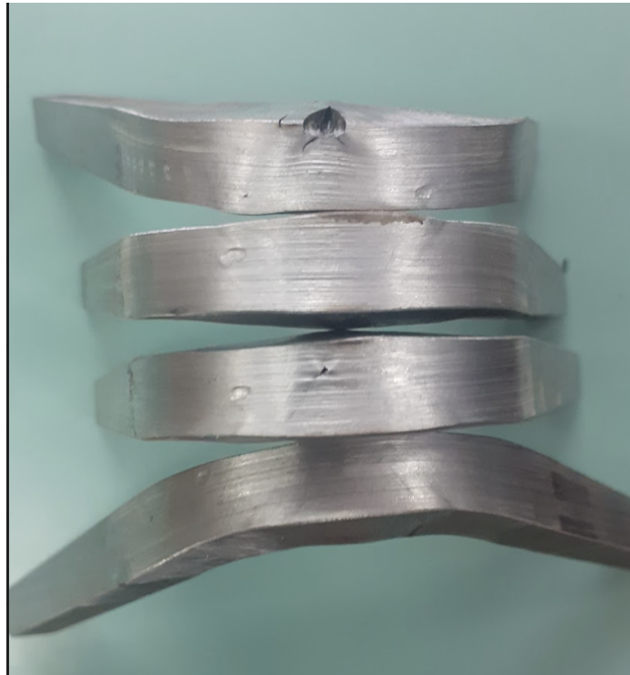
Slika 7.7. Savijeni uzorci su nemaju većih pukotina u usporedbi sa napuknutim primjerom uzorka sa drugog zavara
