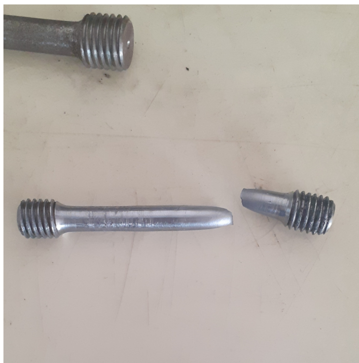
Slika 7.11. Testna epruveta 1 nakon testa vlačne čvrstoće
