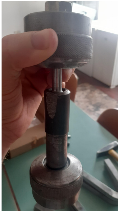
Slika 7.8. Polaganje testne epruvete u prstene od kidalice
