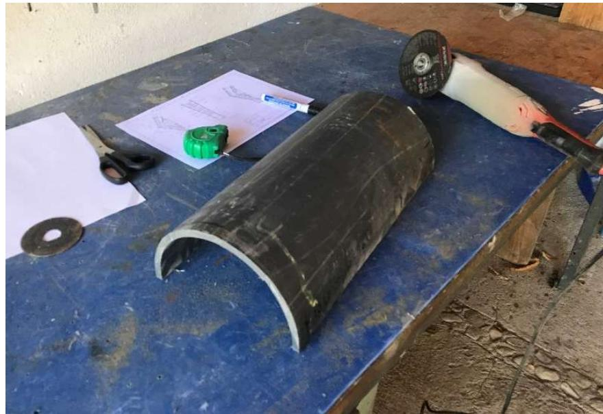
Slika 6.15. PVC-U cijev za izradu bedrenog i lisnog prihvata
