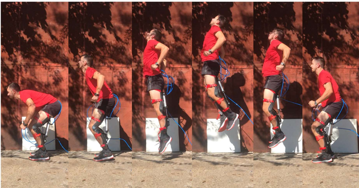
Slika 6.27. Faze skoka pri eksperimentalnom testiranju egzoskeleta
