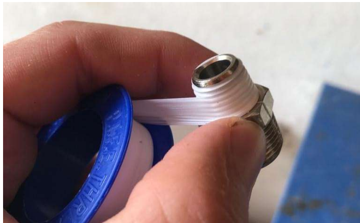
Slika 6.21. Postavljanje teflonske trake na navoj
