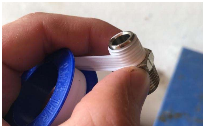
Slika 6.21. Postavljanje teflonske trake na navoj
