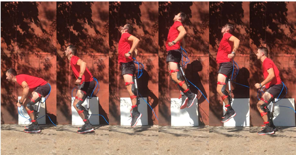
Slika 6.27. Faze skoka pri eksperimentalnom testiranju egzoskeleta
