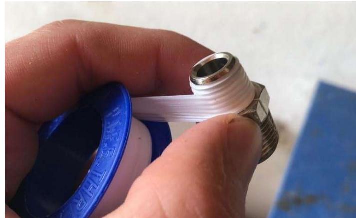
*Slika 6.21. Postavljanje teflonske trake na navoj*
