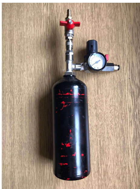
Slika 6.22. Tlačni spremni sa svim montiranim komponentama
