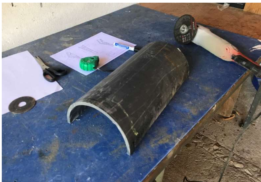
Slika 6.15. PVC-U cijev za izradu bedrenog i lisnog prihvata
