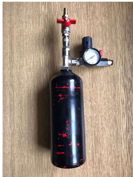
*Slika 6.22. Tlačni spremni sa svim montiranim komponentama*
