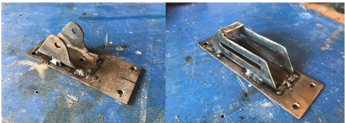
Slika 6.18. Prihvat cilindra (lijevo) i prihvat klipnjače (desno)
