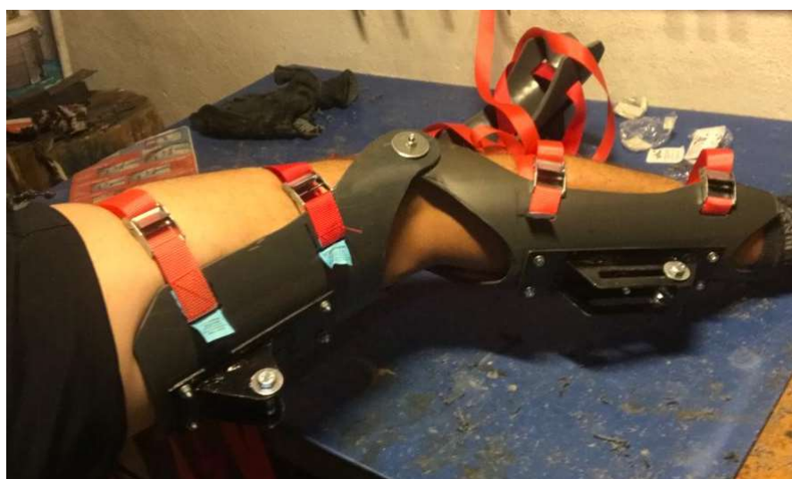
Slika 6.20. Montiranje remena za zatezanje
