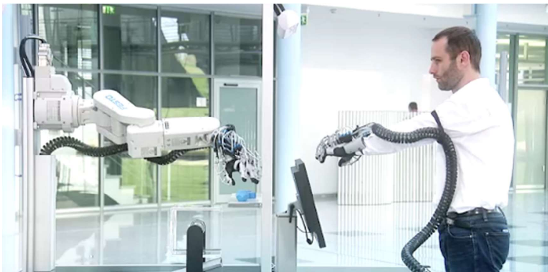
Slika 2.9. Robotska ruka kopira pokrete ExoHand-a [3]
