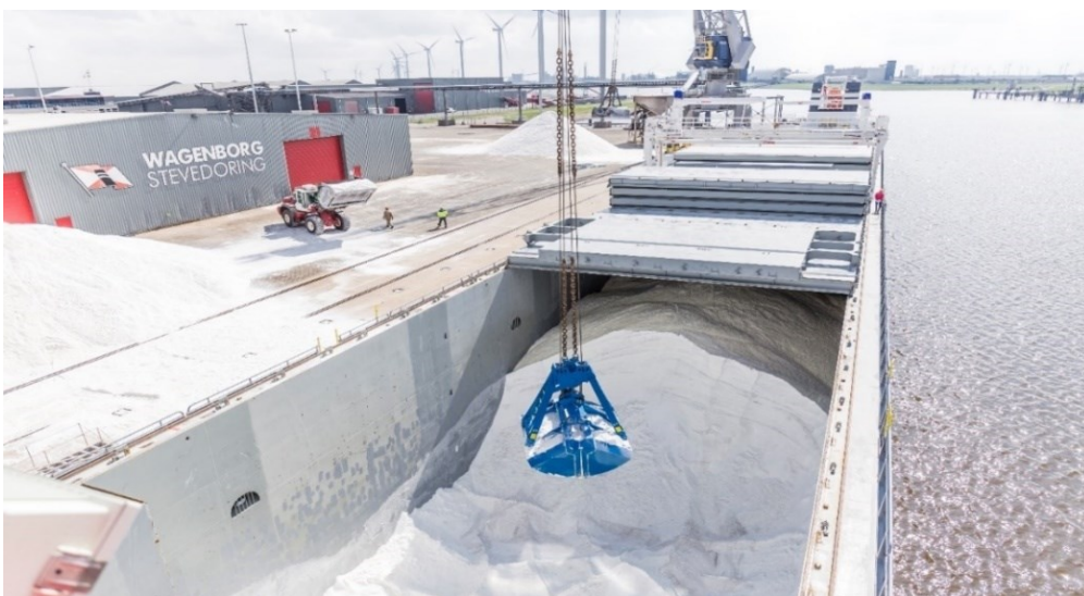
Slika 2.16. Krcanje rasutog tereta na brod za prijevoz općeg tereta
