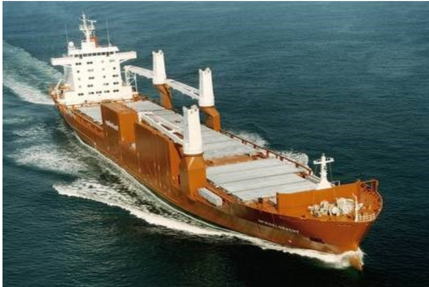
Slika 2.22. Brod za prijevoz općeg tereta opremljen bočnim dizalima
