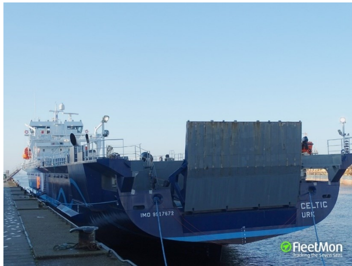
Slika 2.24. Brod za prijevoz općeg tereta opremljen rampom - M/V CELTIC
