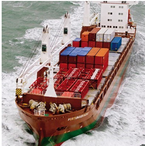
Slika 2.15. Kontejneri na brodu za prijevoz općeg tereta
