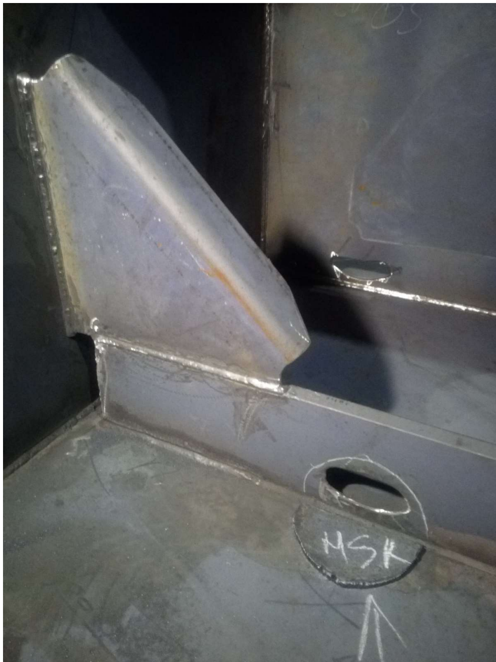
Slika 5.1.1.1 Spoj koljena i tehnološki otvor
