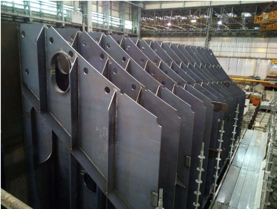
Slika 5.1.1.3 Spoj rebra na oplatu
