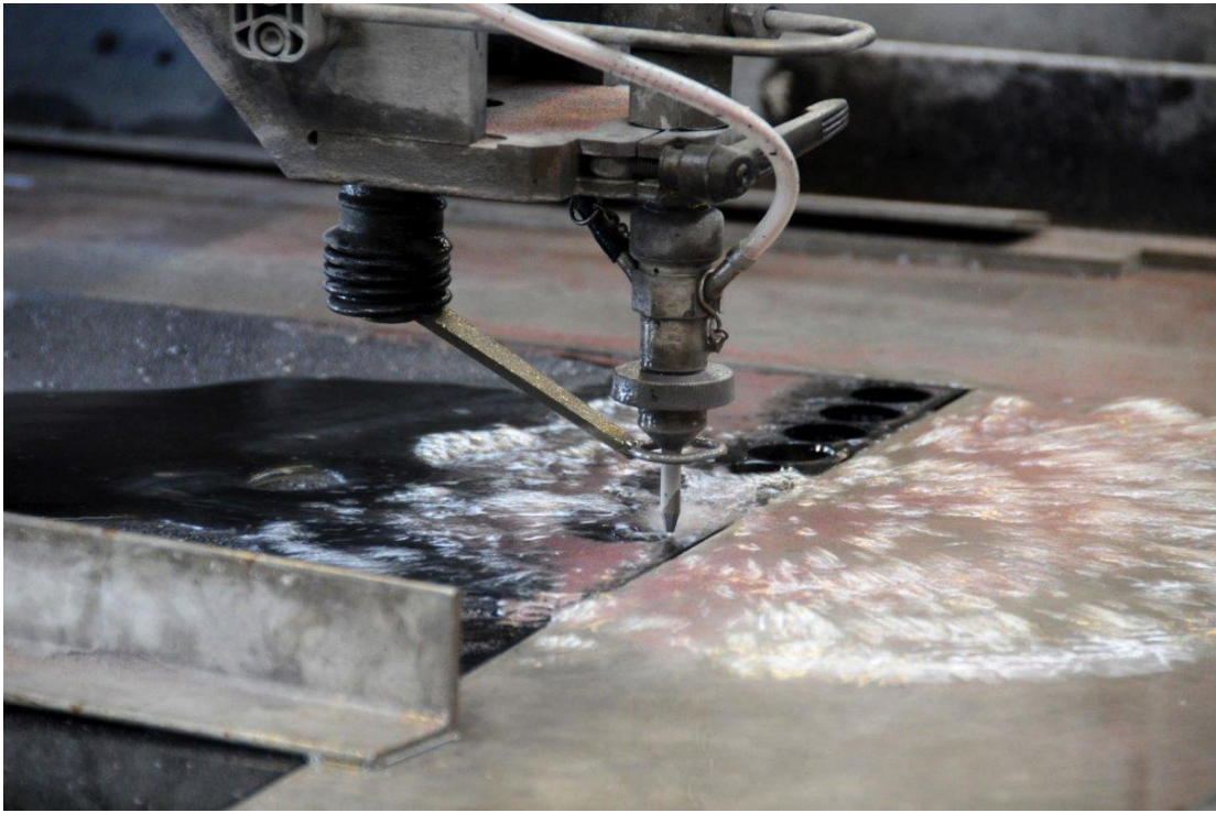
Slika 3.1.2. Rezanje lima vodenim mlazom [9].
