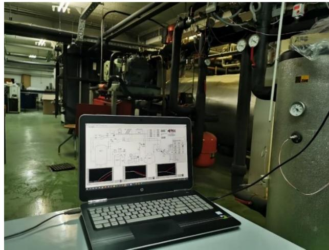
Slika 5.9 Računalo povezano sa sustavima za akviziciju korišteno za praćenje i pohranjivanje mjerjenih temperatura i protoka vode i temperaturna parafina
