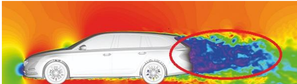
Slika 0.6 Područje odstrujavanje kod automobila [12]
