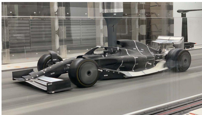
Slika 0.7 Ispitivanje modela u zračnom tunelu [8]
