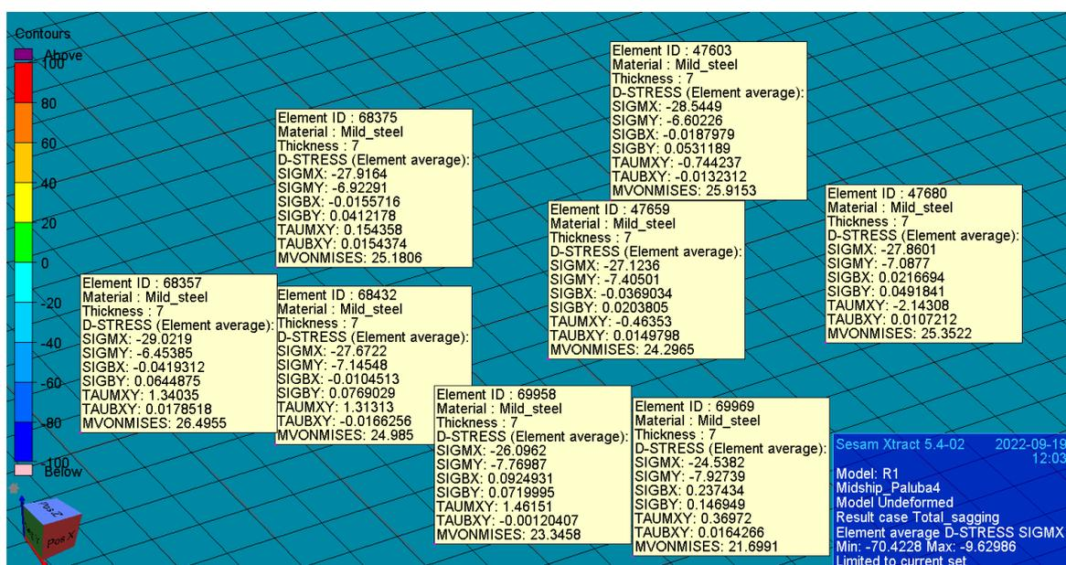
Slika 5.25 Naprezanja Palube 4
