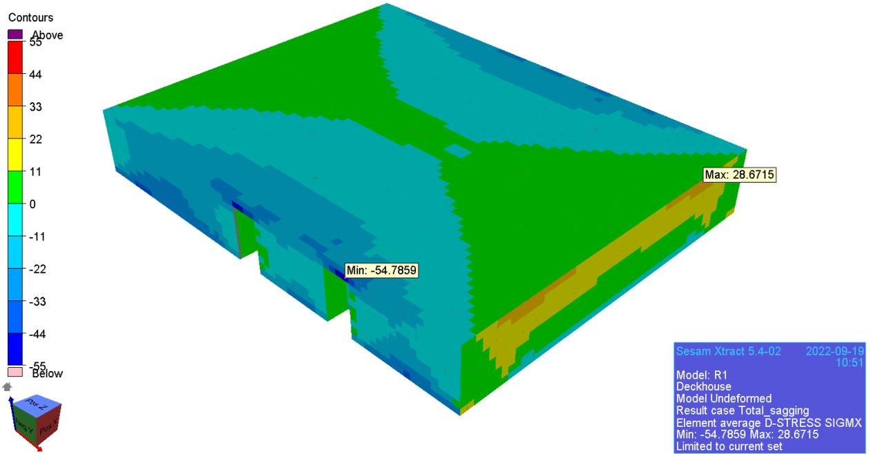
Slika 5.20 Naprezanja  $\sigma_x$  u nadgrađu u stanju progiba
