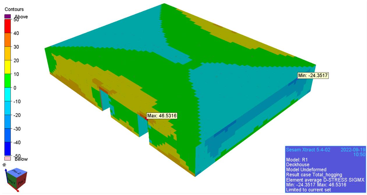
Slika 5.10 Naprezanja  $\sigma_x$  u nadgrađu u stanju pregiba
