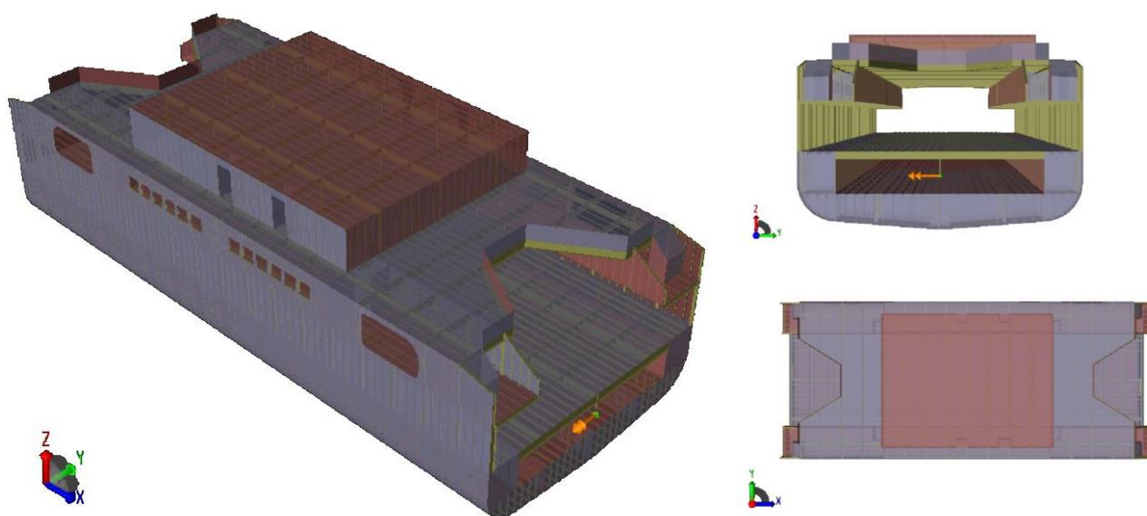
Slika 5.1 Model trajekta izrađen u GeniE programskom paketu
