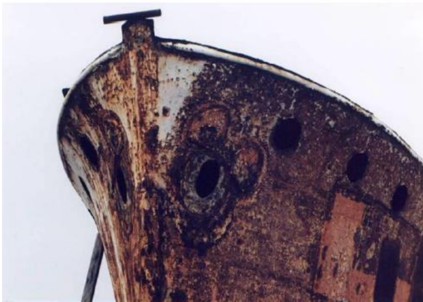
Slika 2.8. Opća korozija čelične oplata trupa broda [7]
