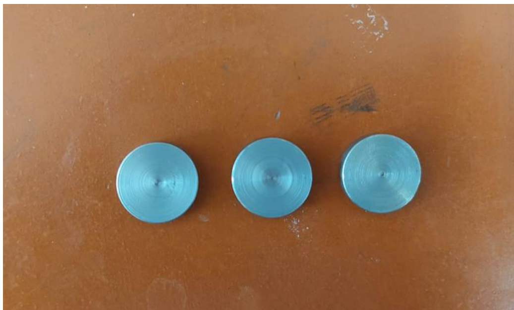
Slika 5.1. Ispitni uzorci od niskolegiranog čelika 42CrMo4
