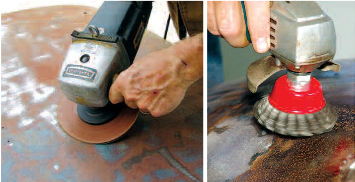
Slika 3.3. Ručno brušenje brusilicom [18]
