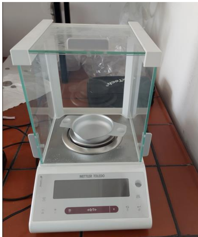
Slika 4.1. Precizna vaga koja se koristi za gravimetrijsko ispitivanje
