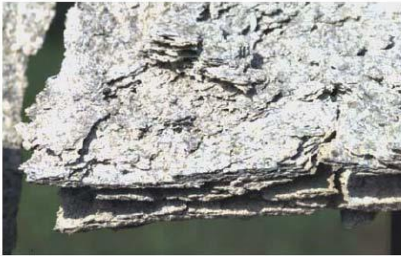
Slika 2.12. Eksfolijacija Al-legure u morskoj atmosferi [6]
