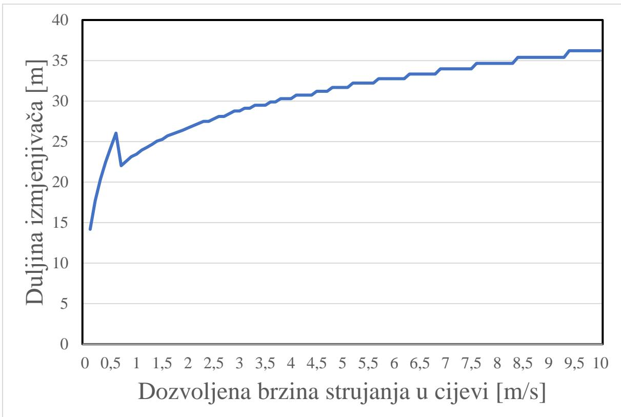
Slika 4.15. Utjecaj brzine strujanja glikol-vode na duljinu izmjenjivača
