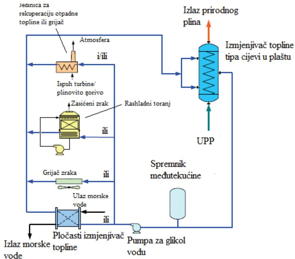
Slika 2.10. Shematski prikaz IFV sustava isparivanja sa raznim pomoćnim izvorima topline [6]
