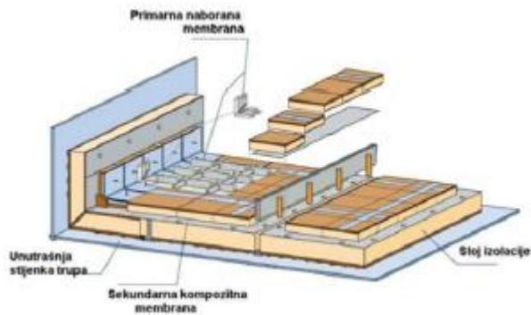
Slika 2.13. Presjek stijenke TGZ Mark III spremnika [8]
