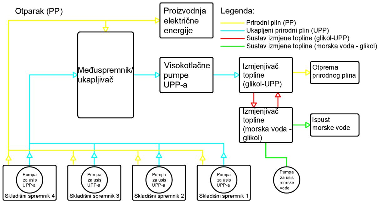
Slika 3.3. Shematski prikaz procesa na FSRU brodu [9]
