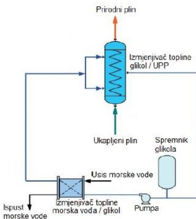
Slika 4.1. Shematski prikaz indirektnog STV isparivača [10]
