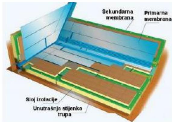
Slika 2.15. Presjek stijenke GTT CS-1 spremnika [8]
