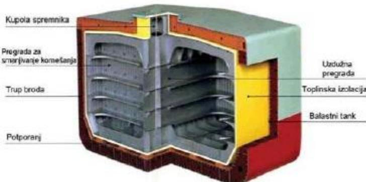
Slika 2.17. Presjek prizmatskog spremnika (tip B) [8]
