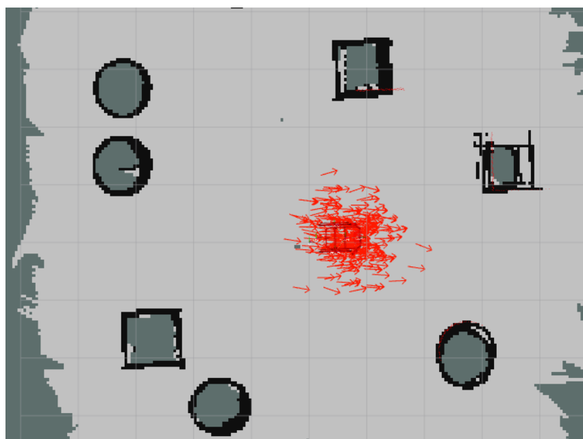
Slika 5.27 AMCL test – stanje nakon kratkog pomaka
