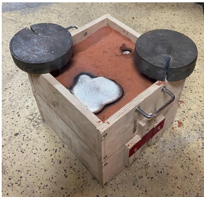
Slika 7.12 Hlađenje taline u kalupu
