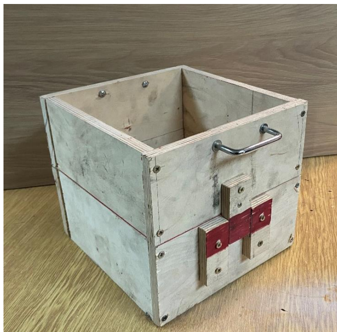
Slika 7.6 Spojeni okvir kalupa
