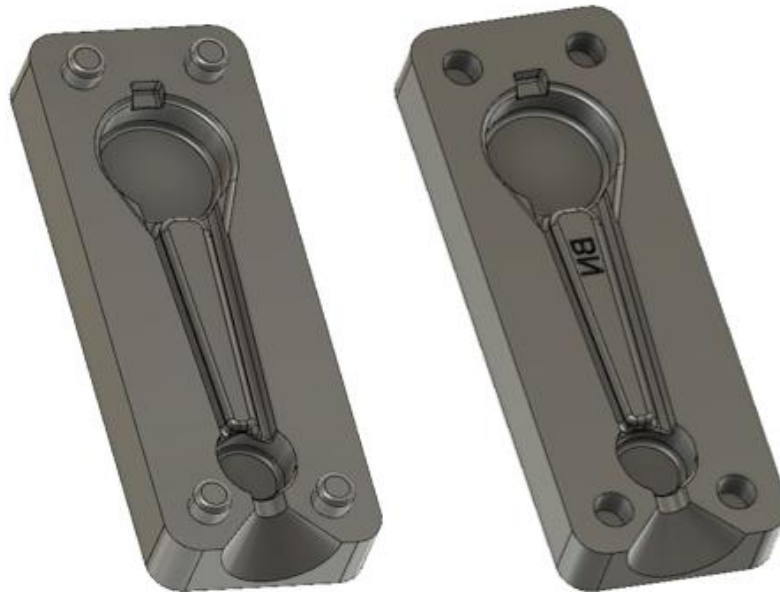
Slika 5.12 Kalup za izradu voštanog modela
