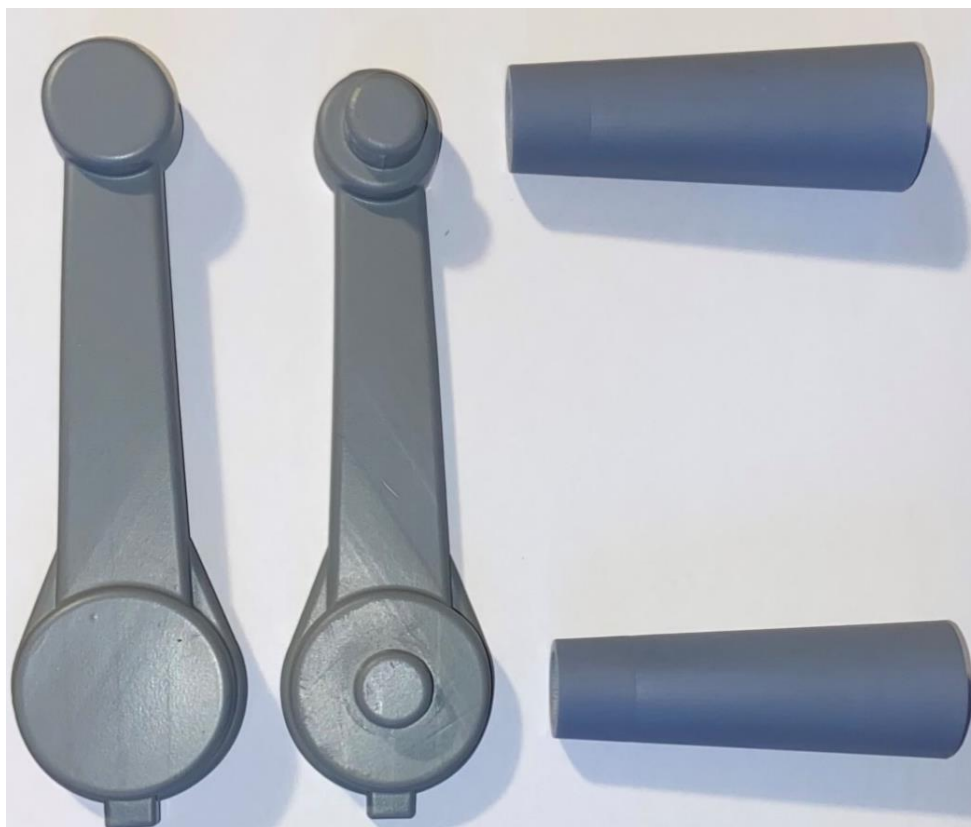
Slika 7.2 Pojednostavljeni model za lijevanje
