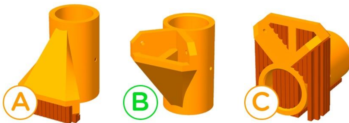
Slika 6.3 Pravilna orijentacija modela u ovisnosti o generiranju potpornjeg materijala
