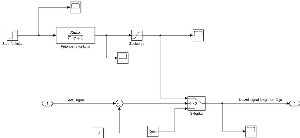
Slika 5.6. Jezgra jednofaznog modela otpornog tipa SFCL-a
