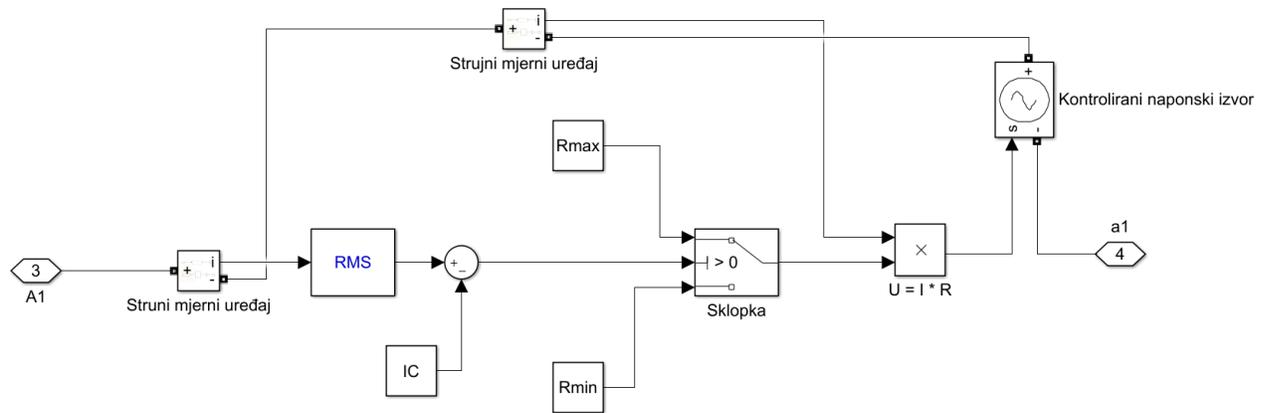
Slika 5.2. Jednofazni step model otpornog tipa SFCL-a
