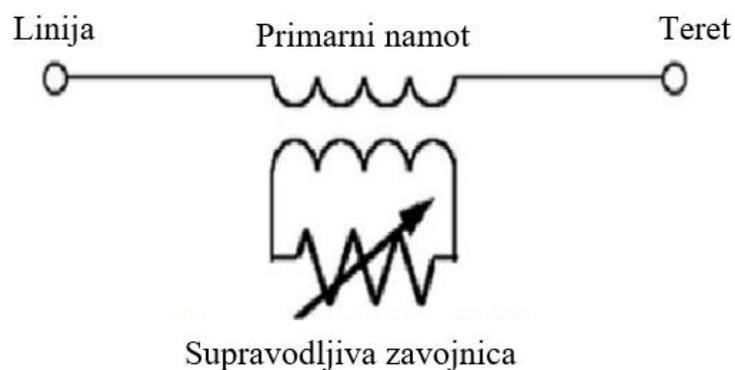
Slika 4.4. Induktivni tip SFCL-a [9]
