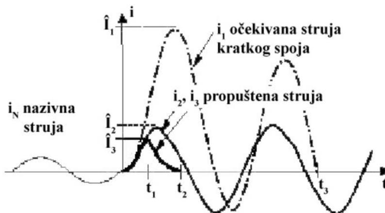
Slika 3.2. Tipični valni oblici struje kratkog spoja [8]
