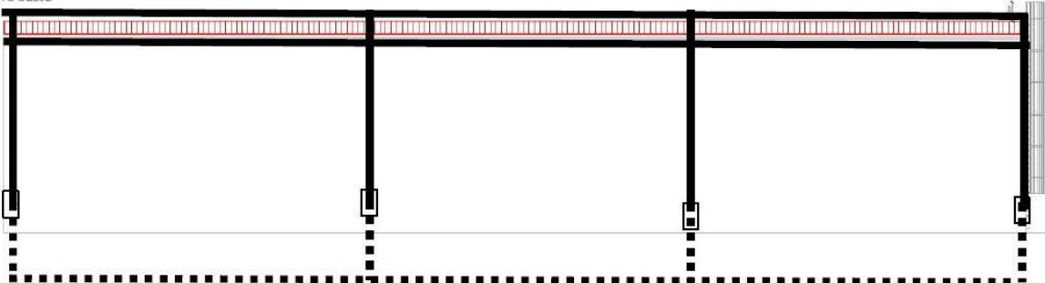
□ MJERNI SPOJEVI NA  $h = 1,8$  (m) OD GOTOVOG PODA
