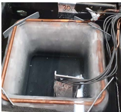
Slika 57. Oblik zalihe leda – bez mješača, ulaz radne tvari odozdo
