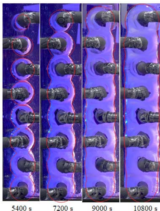
Slika 31. Usporedba simuliranih (crvene linije) i realnih (snimka) profila zalihe leda [112]
