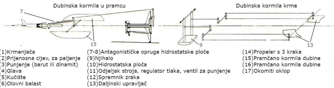
Slika 4.2. Nacrt s dijelovima prvog torpeda
