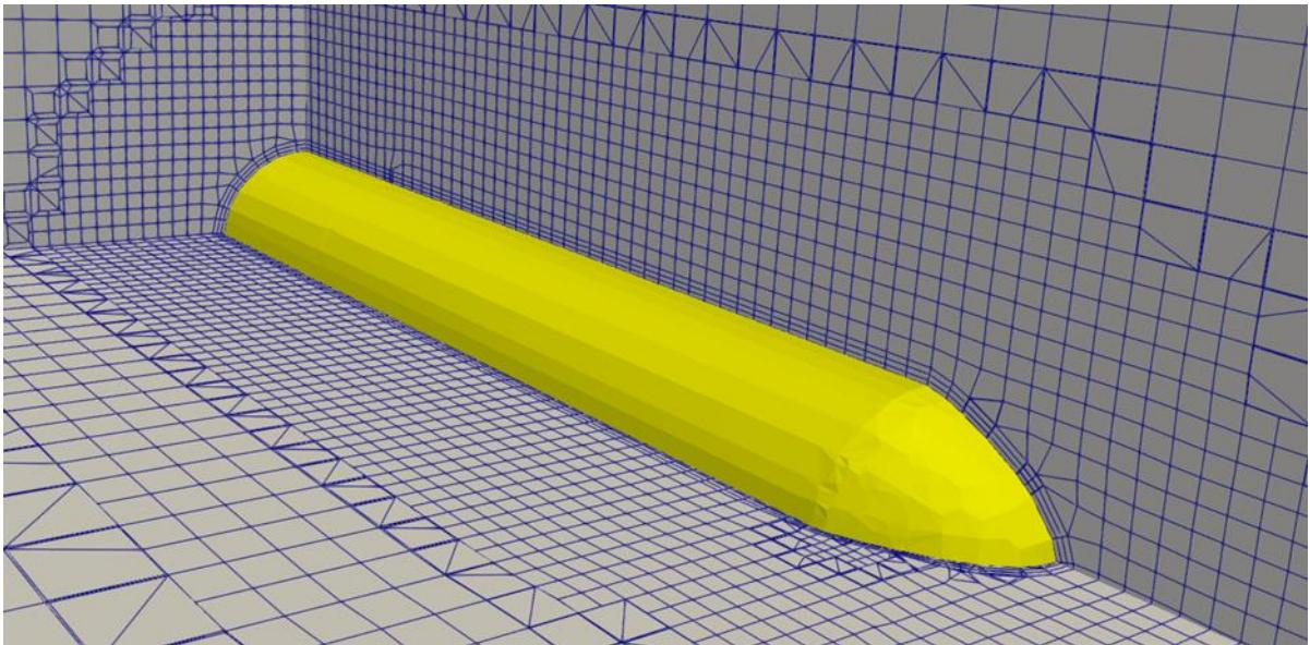
Slika 4.20. Granični sloj uz stjenku trupa – 18in Fiume Mark III\*\* H torpedo
