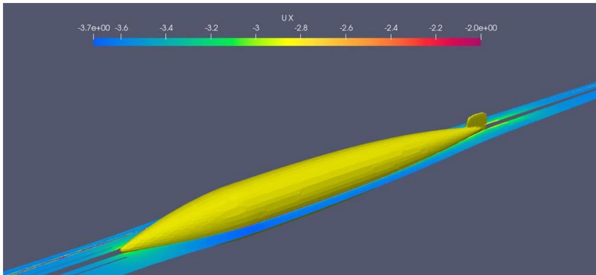
Slika 4.16. Strujnice uzdužne komponente brzine fluida – Siluro A.22
