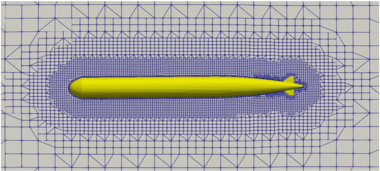
Slika 4.19. Diskretizirana domena u području trupa torpeda – 18in Fiume Mark III\*\* H torpedo
