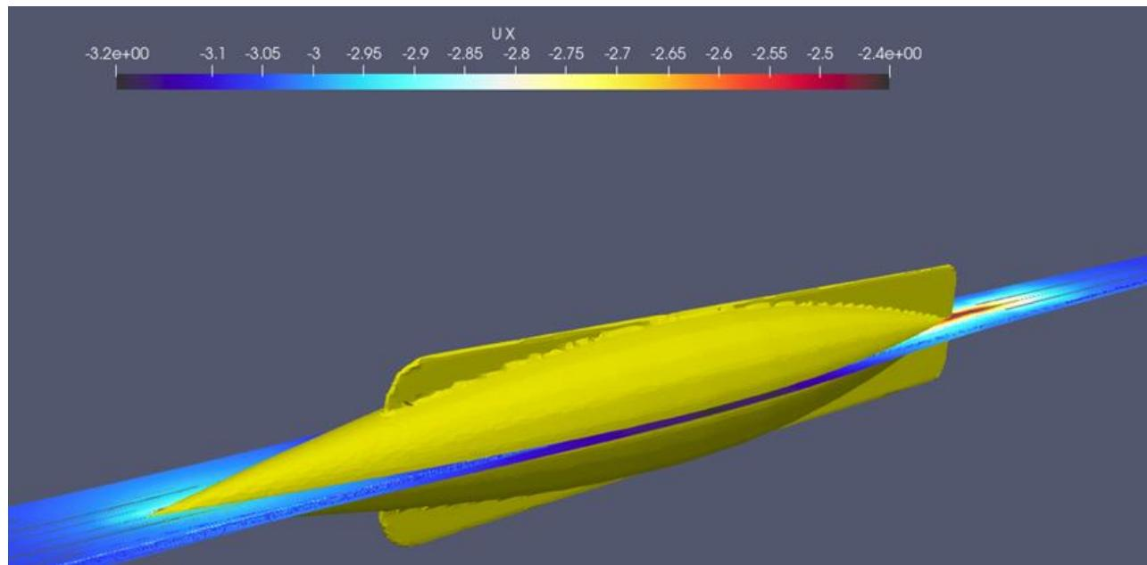
Slika 4.8. Strujnice uzužne komponente brzine fluida – Siluro Whitehead
