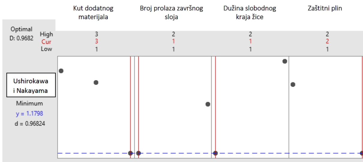
Slika 5.3. Parametri zavarivanja u kojima se javljaju najmanje koncentracije naprezanja
