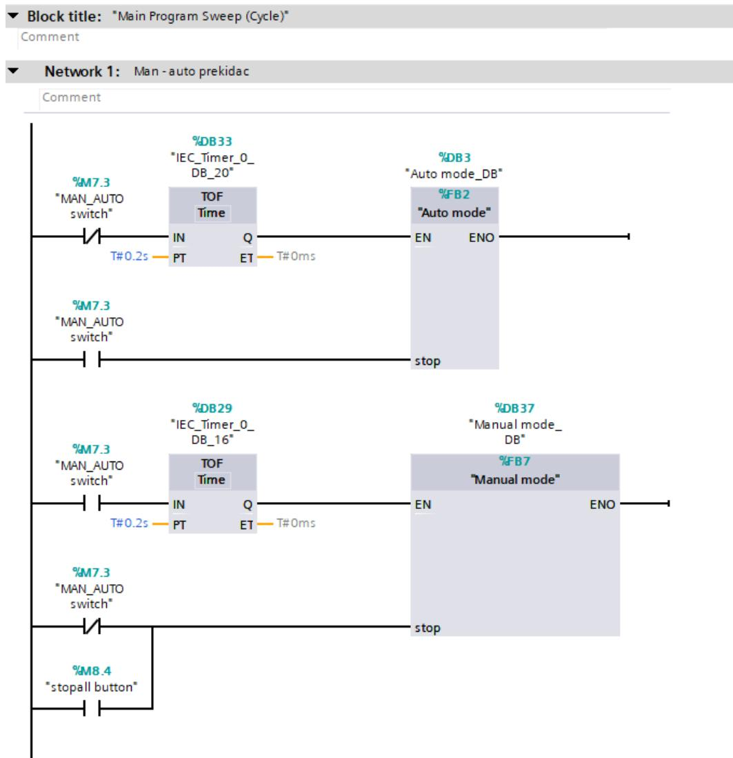
Slika 4.2. Odabir ručnog ili automatskog načina rada
