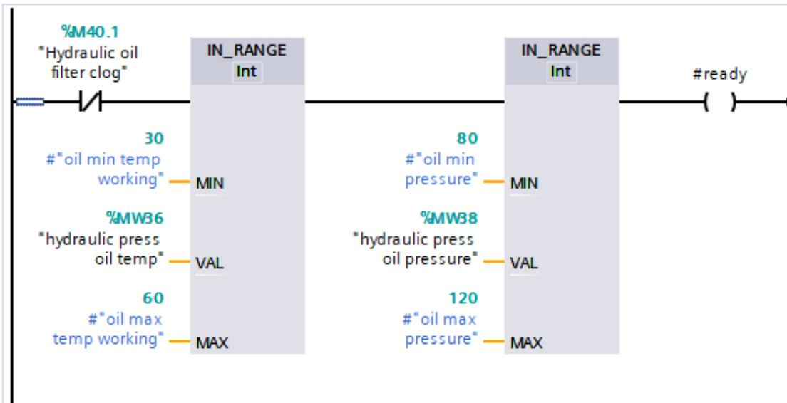
Slika 4.21. Dozvola za rad hidraulične preše
