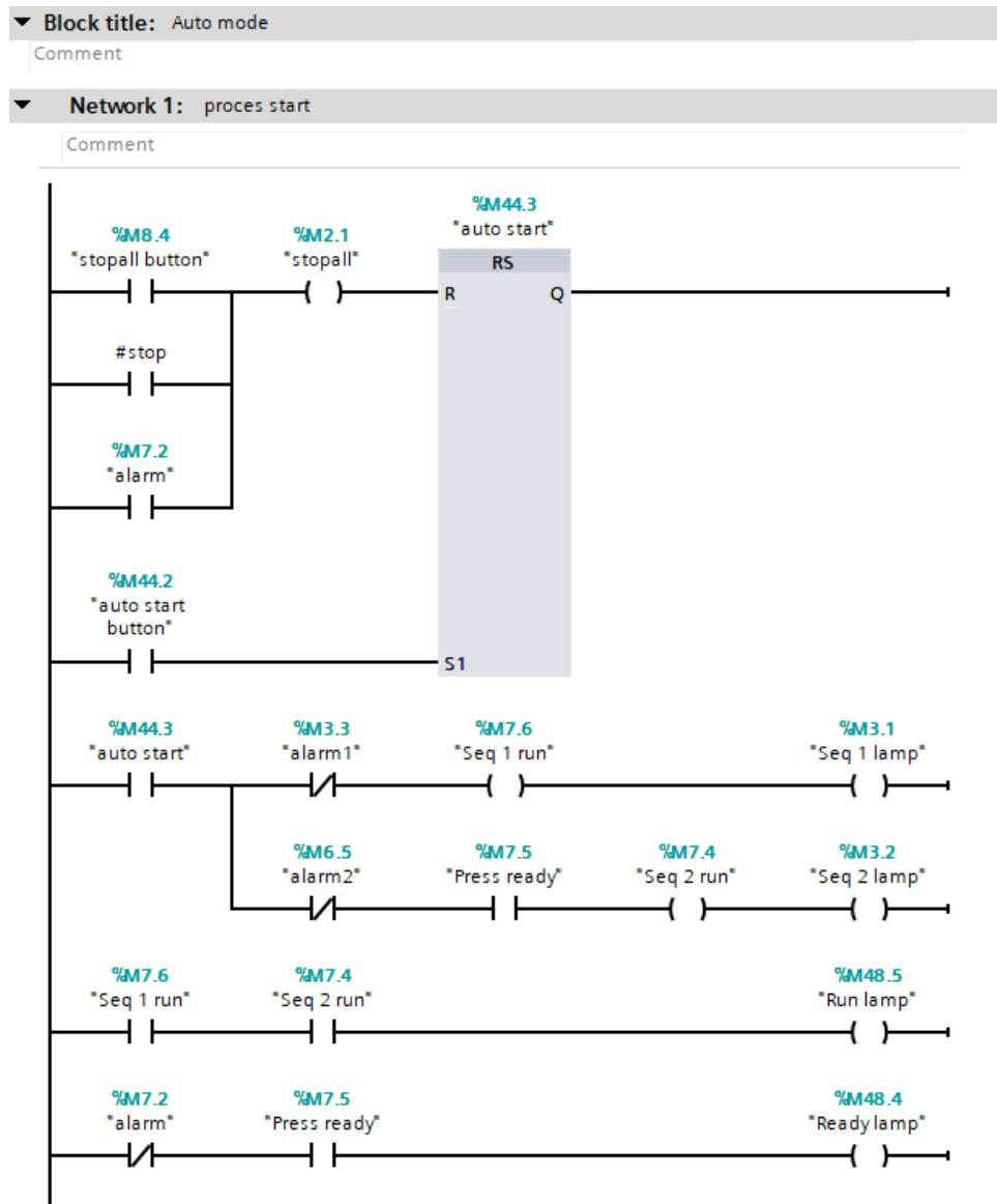
Slika 4.3. Pokretanje procesa u automatskom načinu rada
