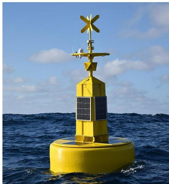
*Slika 2. 9. Senzor za mjerjenje stanja mora*
