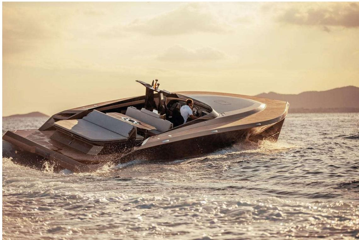
Slika 2.6.3.SAY 42, brod izrađen od kompozita ojačanog ugljičnim vlaknima [15]
