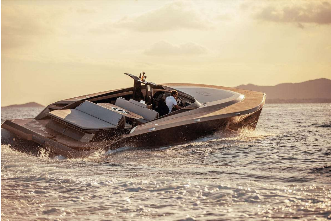
Slika 2.6.3.SAY 42, brod izrađen od kompozita ojačanog ugljičnim vlaknima [15]
