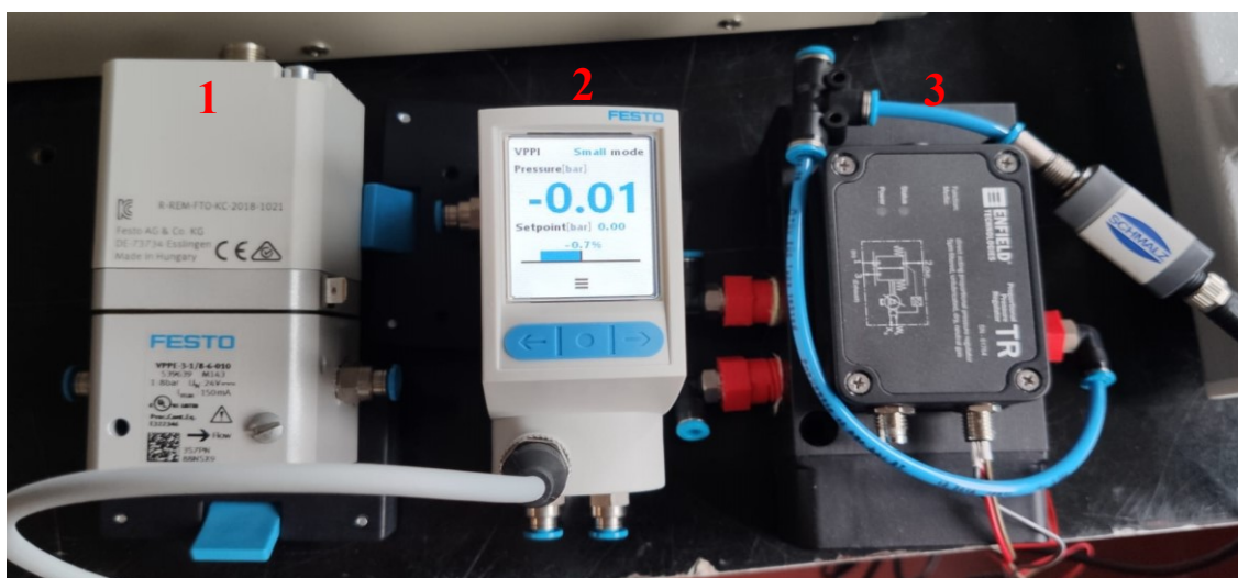
Slika 4.3 Proporcionalni regulatori tlaka: 1 – Festo VPPE, 2 – Festo VPPI, 3 – Enfield TR
